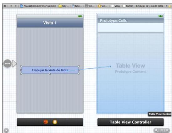
**Fig. 2.219:** Conexión del botón con el *Table View Controller*
