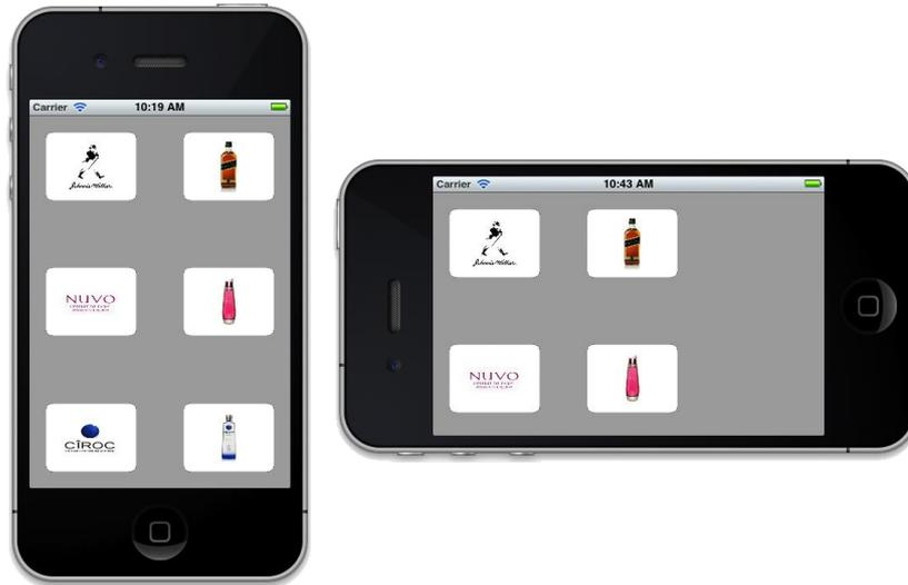
**Fig. 2.174:** Componentes desaparecidos al girar el dispositivo *iOS*
