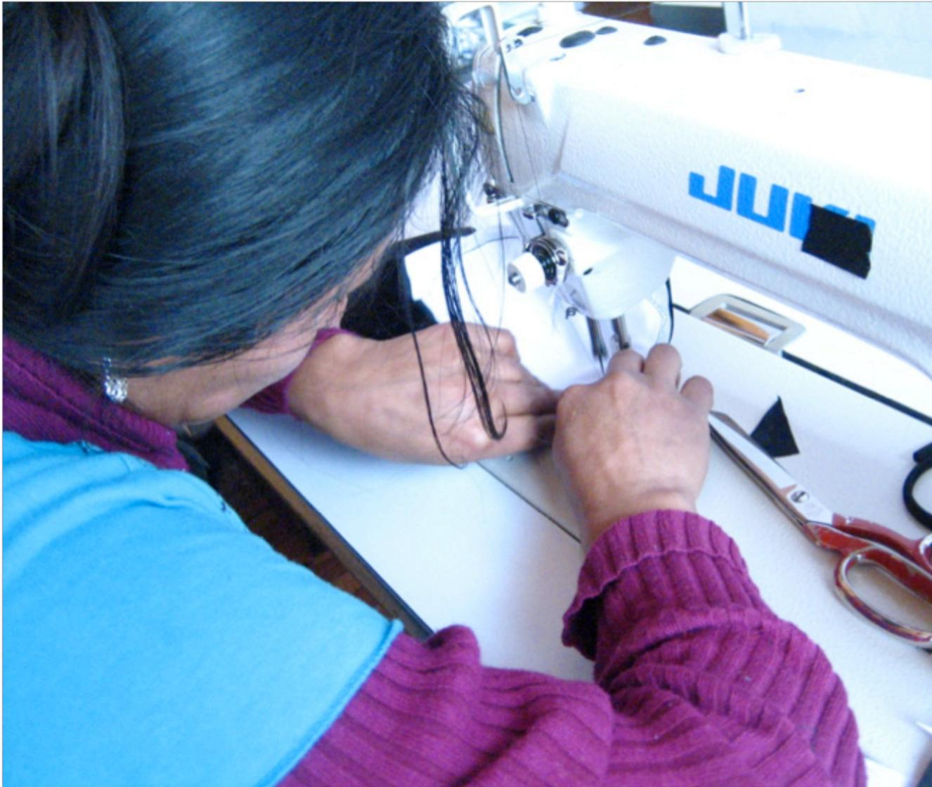
Y finalmente se cosen los bordes del traje de baño en la máquina recubridora a la cual se le debe adaptar una pieza frontal para que haga la costura con el dobladillo de la tela y así podemos darle un acabado de mejor calidad.
