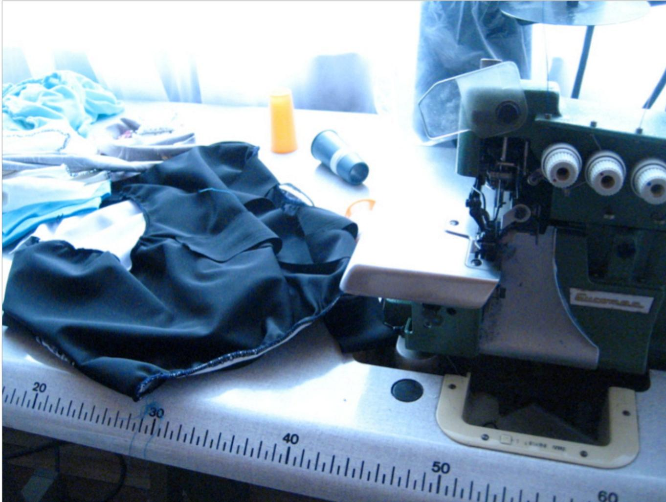
4) En la etapa de confección de las prendas, se coserán en primer lugar los forros de los protectores del panty a la lycra en la máquina overlock y luego se procede a coser elástico en los huecos de las piernas y en la cintura para que el traje de baño se estire lo suficiente y se adapte al cuerpo.
