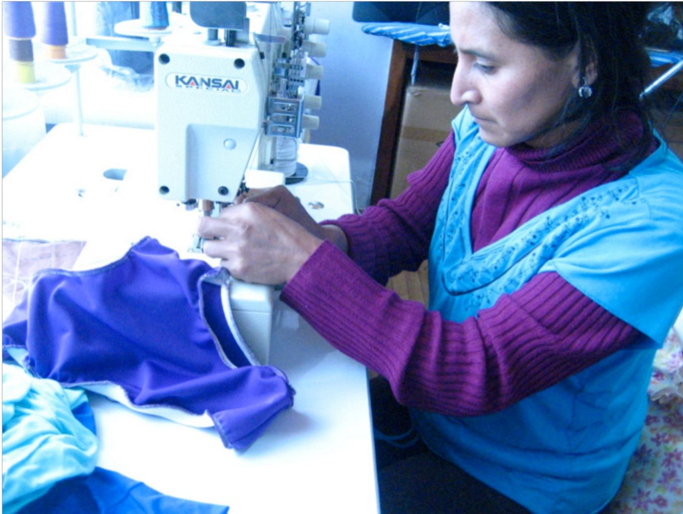
Después se hacen los terminados en la máquina recubridora donde se cosen los bordes del panty en los huecos de las piernas y en la cintura.
