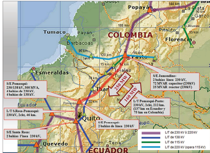
Fig. 26 Esquema Interconectado con Colombia Fuente: CELEC EP – Transelectric
