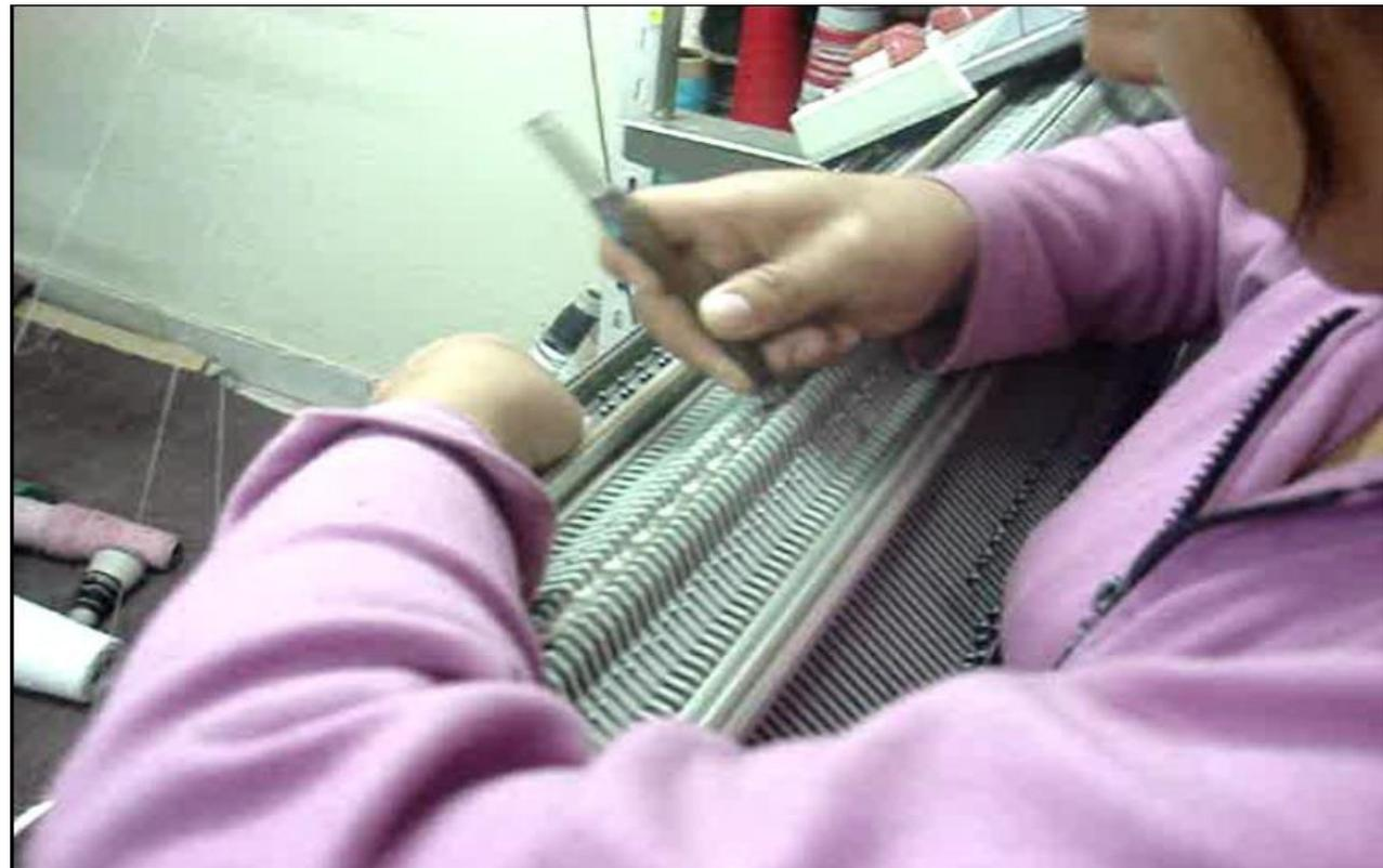
En la foto se muestra como pasa los puntos de la frontura delantera a la frontura trasera.
