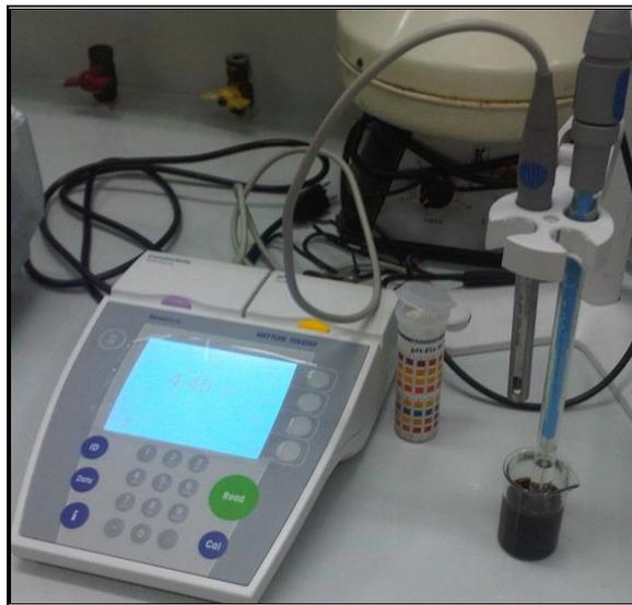
Figura 20: Potenciómetro digital para medición de pH.
