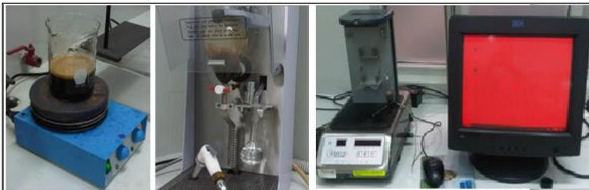
Figura 15,16,17: Eliminación de la espuma, destilado y medición del grado alcohólico.
