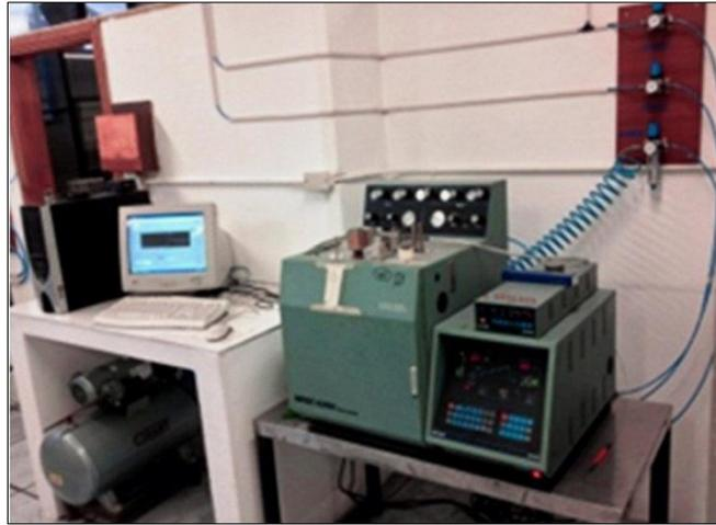
Figura 5: Cromatógrafo de gases
