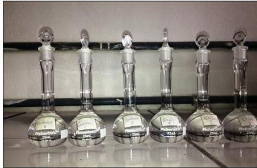
Figura 7: Muestras preparadas mediante el método del patrón interno
