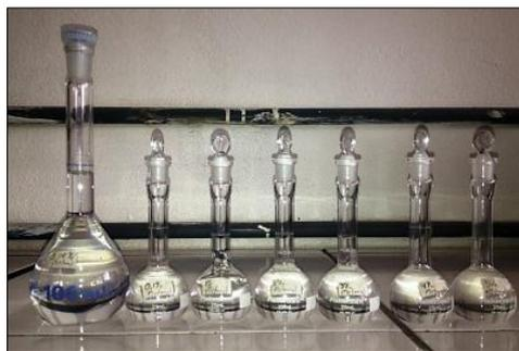
Figura 6: Patrones para metanol mediante el método del patrón interno
