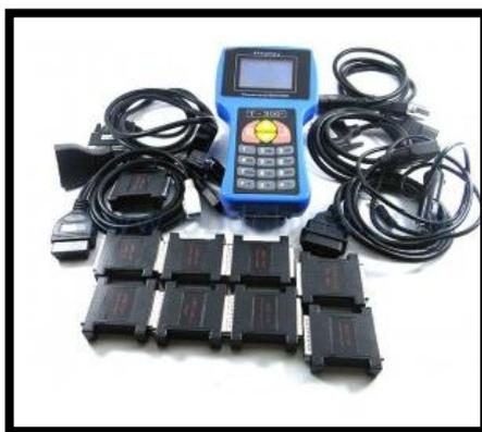
Figura 2. 6 Programador y extractor de codigos T300
