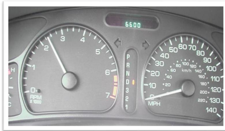
Figura 1.15 En el panel se observa las rpm y la posición de la palanca selectora (D)
