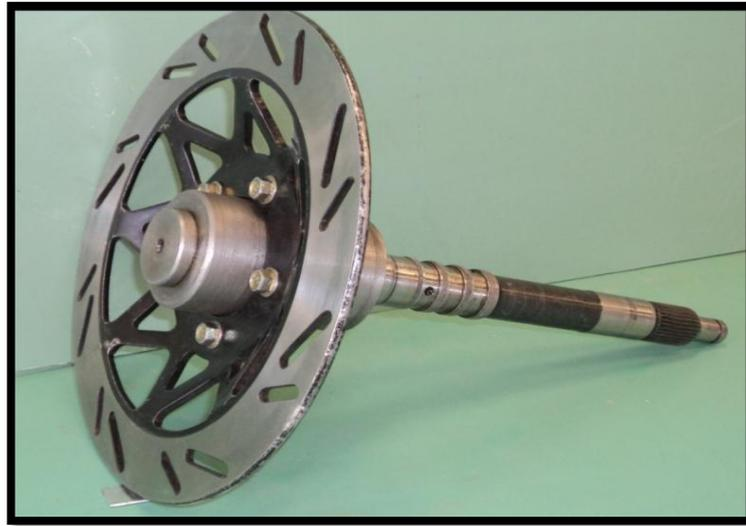
Figura 3.25 Montaje del disco de freno
