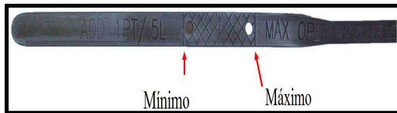
Figura 1.13 Nivel del fluido de la transmisión
