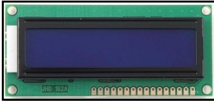
Figura 3.36 Pantalla de cristal líquida (LCD 2X16)
