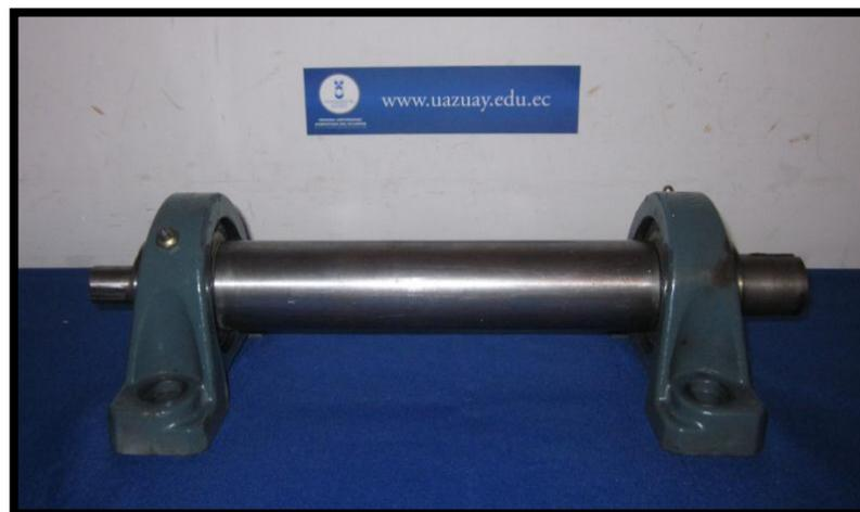
Figura 3.13 Montaje de las chumaceras en el eje
