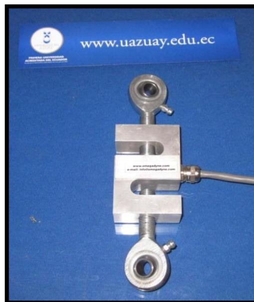
Figura 3.37 Celda de carga en forma de S
