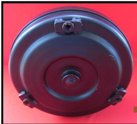
Figura 3.17 Convertidor hidráulico de par 4L60-E
