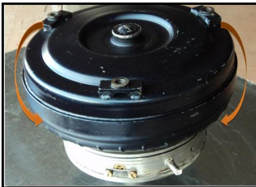
Figura 4.15 Prueba de interferencia entre Estator e Impulsor
