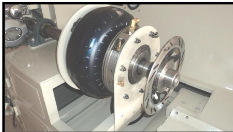
Figura 3.22 Montaje del eje de la turbina
