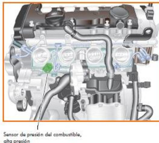
Fig. 2.42 Sensor de alta presión.
