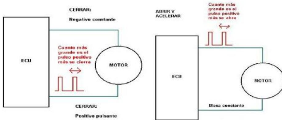
Fig. 2.11 Polaridad en el motor del TAC.
