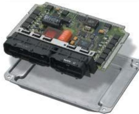
Fig. 1.24 Estructura interior de la E.C.U.
