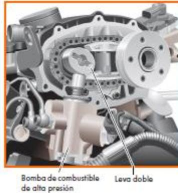
Fig. 2.32 Modo de accionamiento de la bomba.
