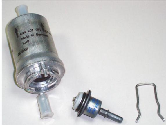
Fig. 2.50 Filtro con válvula limitadora de presión.
