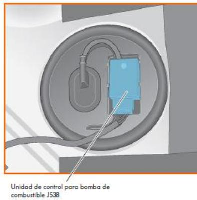
Fig. 2.48 Unidad de control de la electrobomba.
