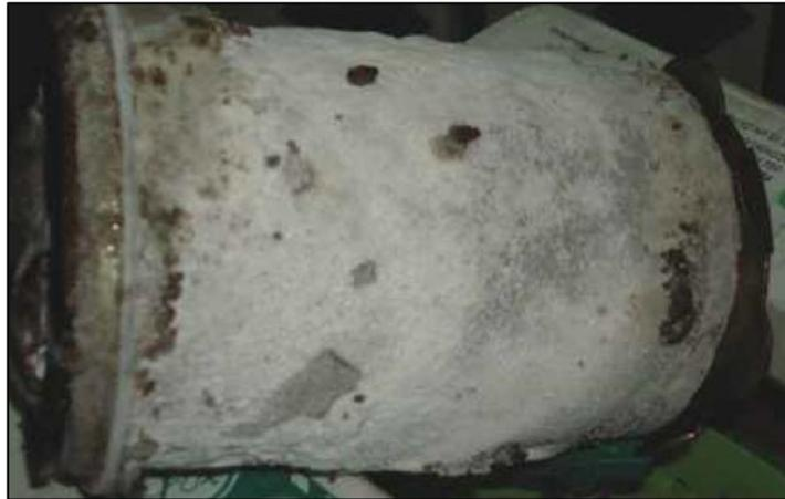
Fig. 4.2: Piedra de filtro saturada de humedad y corrosión del sistema
