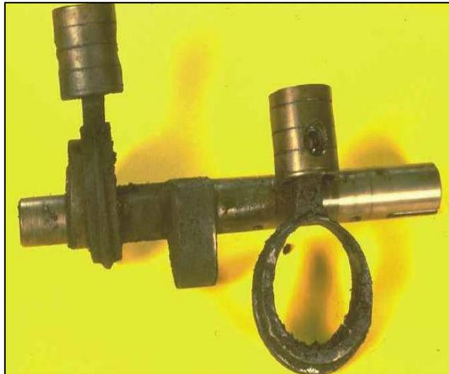
Fig. 4.1: Corrosión en elementos de un compresor
