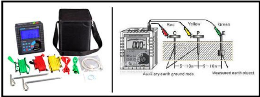
**Figura 4.8.** Medidor Digital de Resistencia a Tierra ETCR3000.
