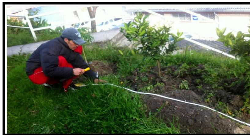
**Figura 4.9.** Medición de la Resistividad del terreno.
