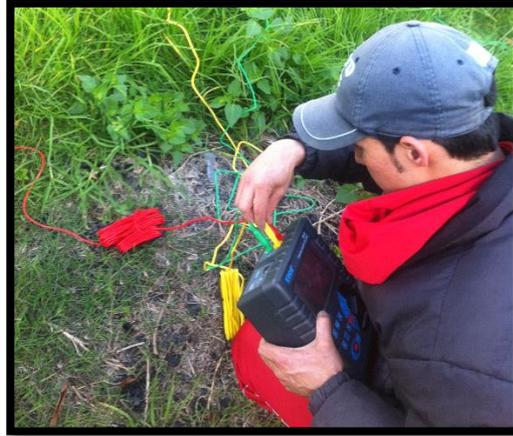
**Figura 4.10.** Medición de Resistencia de Puesta a Tierra.
