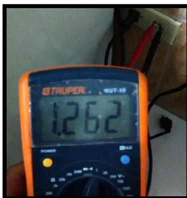
**Figura 4.14.** Medición de Resistencia de Puesta a Tierra en un tomacorriente polarizado.
