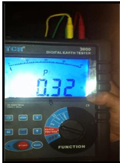
**Figura 4.12.** Medición de Resistencia de Puesta a Tierra en el Departamento de Imágenes y Diagnóstico.
