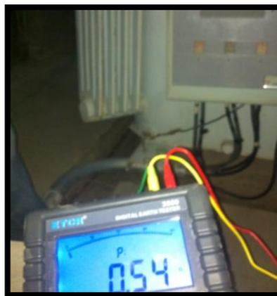
**Figura 4.11.** Medición de Resistencia de Puesta a Tierra en el Transformador de Distribución.
