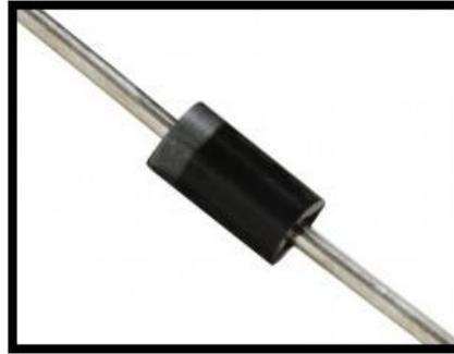
Figura 3.20 Diodo de Potencia
