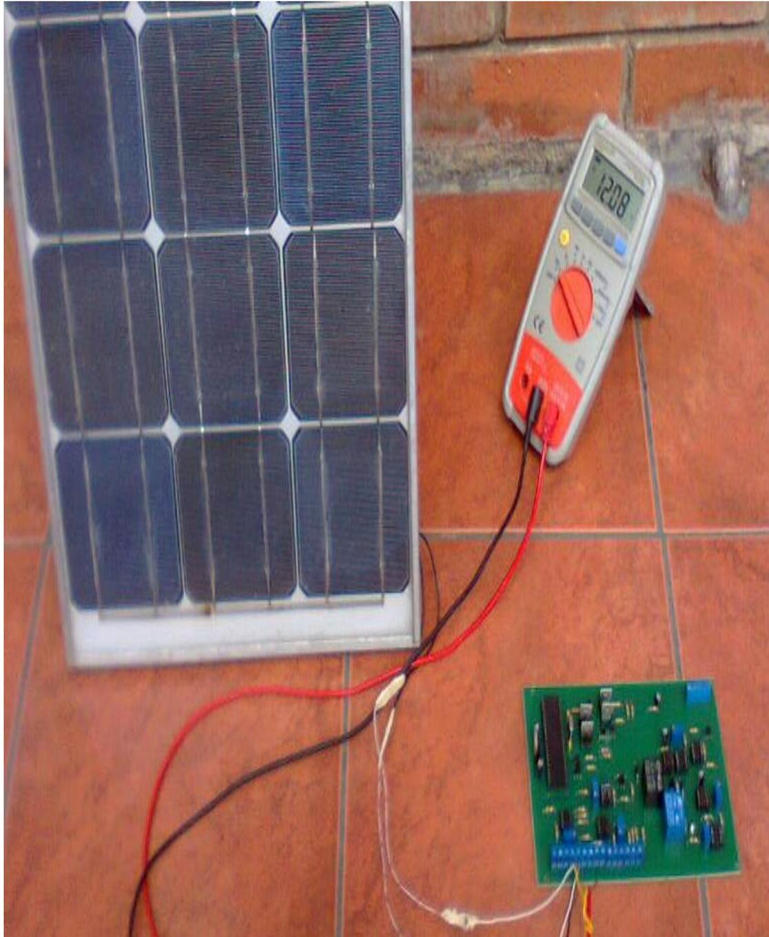
Figura 6.5 Voltaje de entrada que Genera el Panel Solar
