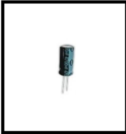
Figura 2.9 Condensador
