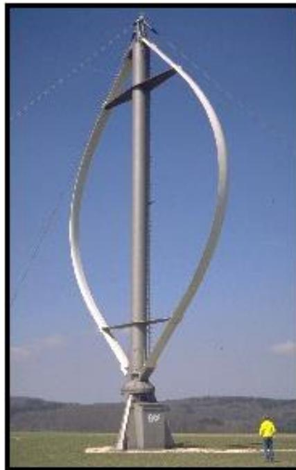
Figura 1.23 Aerogenerador de eje Vertical
