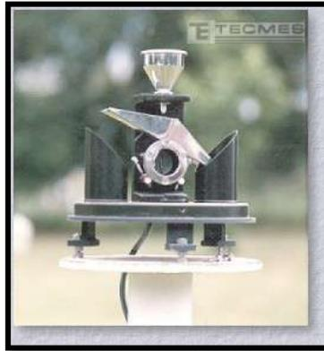
**Figura 2.4: Pluviómetro de la empresa argentina TECMES**
