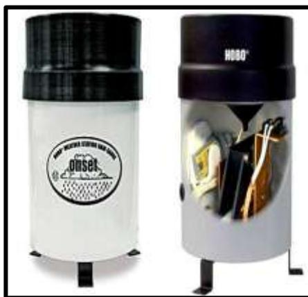
**Figura 2.1: Pluviómetro basculante vista por su exterior e interior**
