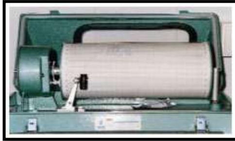
**Figura 2.7: Limnómetro**
