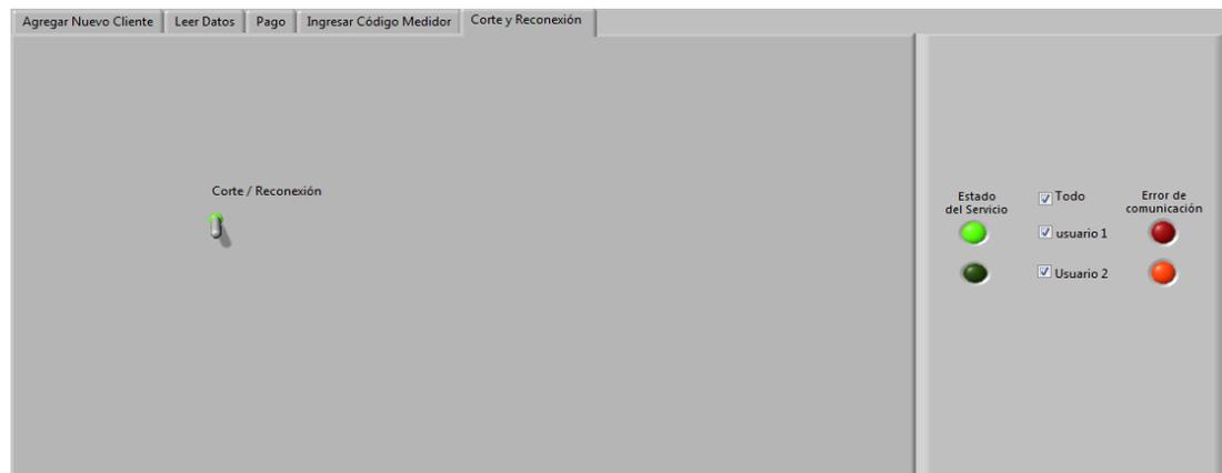
Figura 4. 28: Visualización del estado del servicio con la una tarjeta en estado conectado y la otra desconectada
