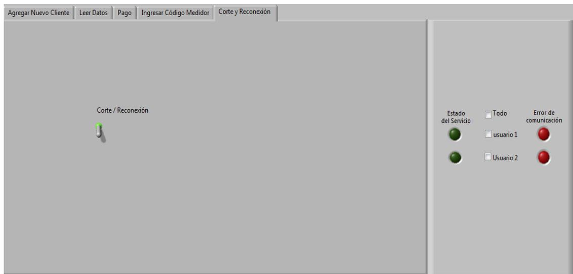
Figura 3. 18: Panel Frontal de Corte y Reconexión
