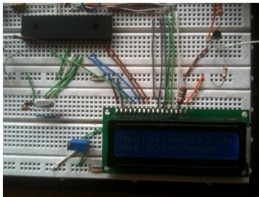
Figura 4. 2: Funcionamiento del microcontrolador y LCD
