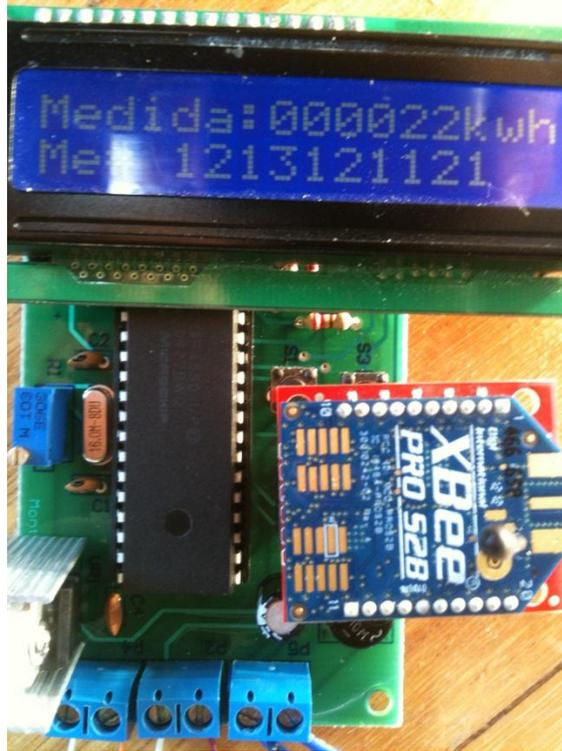
Figura 4. 10 (a): Prueba 1 Funcionamiento del contador de pulsos
