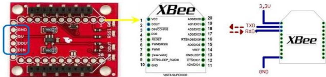
Figura 2. 4: Tarjeta reguladora de voltaje y distribución de pines
