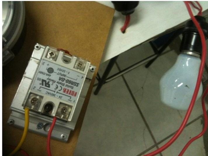
Figura 4. 27: Relé en estado de corte para la tarjeta 1
