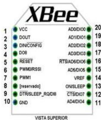
**Figura 2. 3:** Distribución de Pines Xbee S2B
