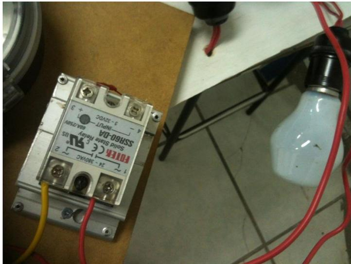
Figura 4. 31: Relé en estado de corte para la tarjeta 1
