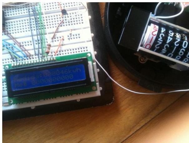
Figura 4. 8: Primera medición de pulsos
