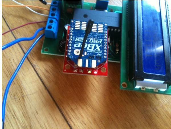
Figura 4. 11: Funcionamiento del Xbee en la placa
