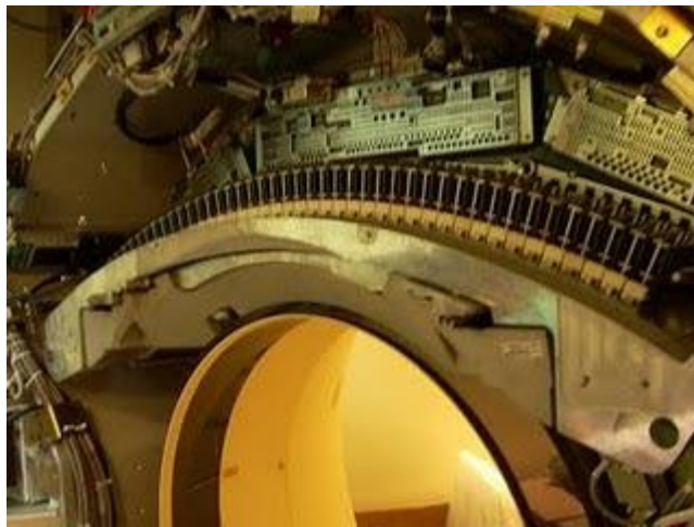
Figura 1.6: Conjunto de detectores distribuido en forma de abanico.
