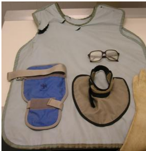
Figura 4.4: Protectores con plomo contra la radiación.
