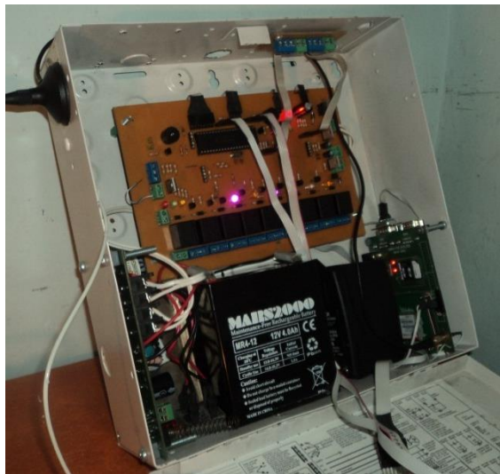
Figura 5.33. Conexiones del Sistema de Control mediante SMS
