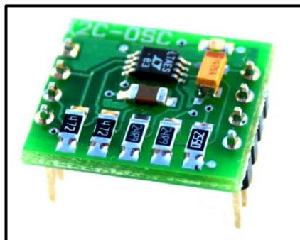
Figura 1.13. Oscilador Digital LTC6904 de Linear Technology
