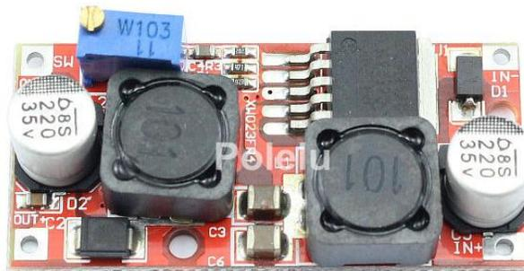
**Figura.2.2** Circuito convertidor dc a dc.
