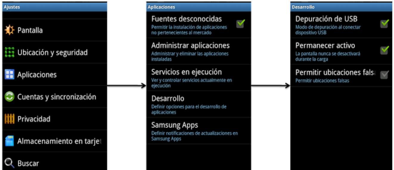
**Figura.4.1.1** Configuración en el teléfono Android
