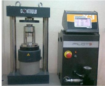
**Fotografía A3-1.** Prensa para determinar la resistencia a la compresión de cubos de 50 mm y cilindros de 20 cm de alto
