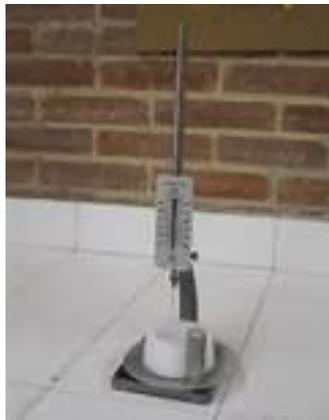
**Fotografía A3-3.** Aparato de Vicat, utilizado para determinar el tiempo de fraguado y consistencia normal, según INEN 196.
