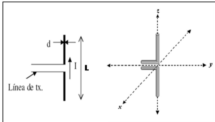
**Fig. 1.10. Antena Dipolo.**
