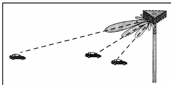
**Figura 2.22: Radiación - Antena de Haz Adaptativo.**
