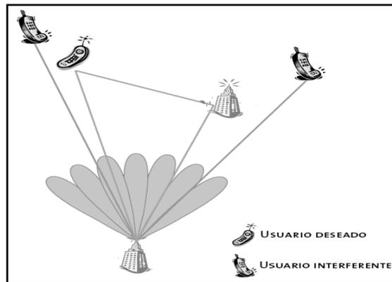
**Figura 2.12. Antena de Haz Conmutado**
