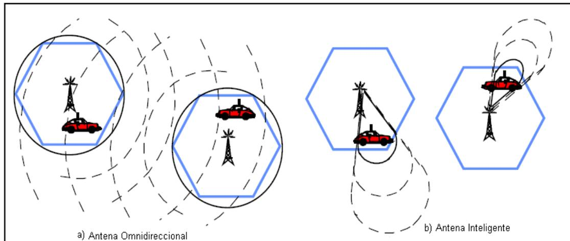
**Fig.2.28: Reducción de interferencia.**
