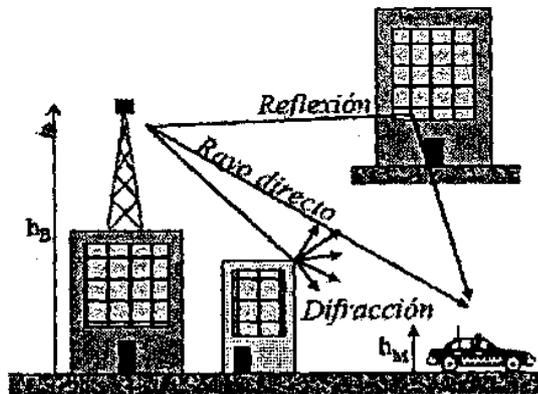
**Fig. 3.2: Fenómenos físicos en la propagación de la señal.**
