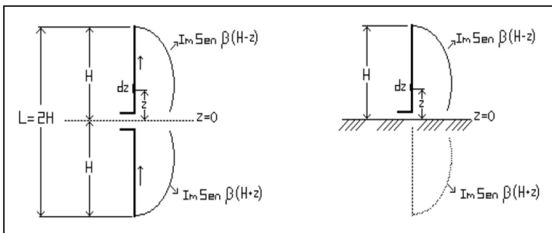
**Fig 1.15: Dipolo alimentado en su centro con una distribución**
