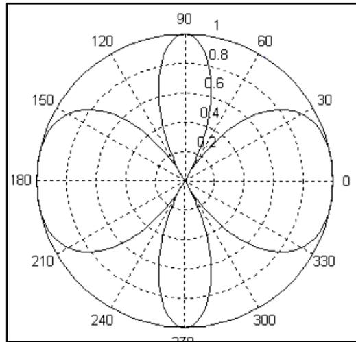
Fig. 4.14 Radiación de 2 antenas isotrópicas,  $d = \lambda$ .
