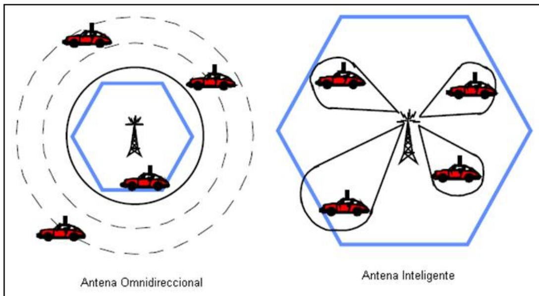
**Fig.2.27: Rango de extensión usando SA.**
