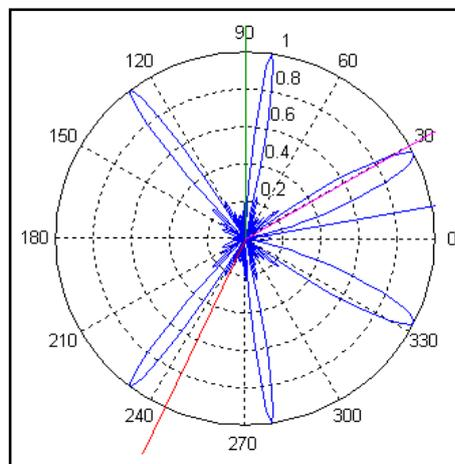
**Fig 5.1 Diagrama de radiación del sistema adaptativo.**
