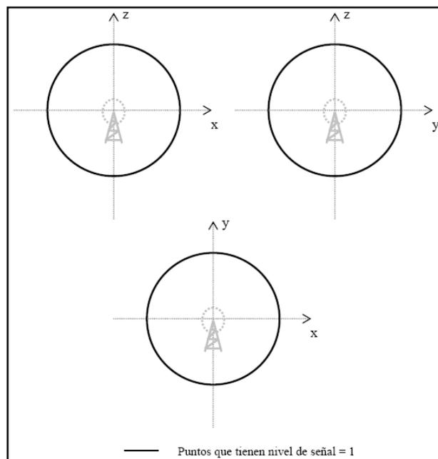
**Fig 1.16: Antena Isotrópica.**
