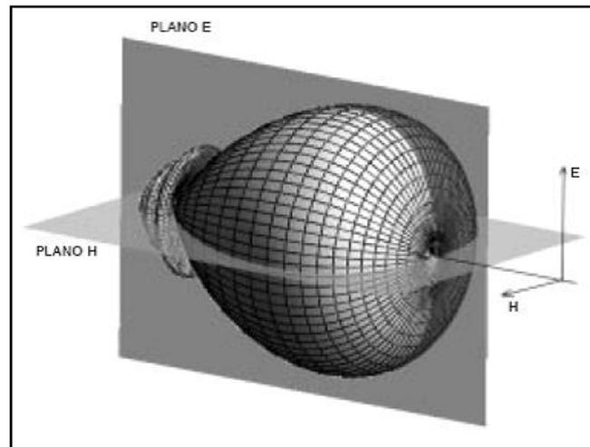
**Fig. 1.7. Diagrama tridimensional de una antena en los plano E y H.**
