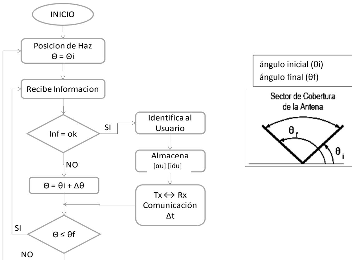
Figura 2.18. a) diagrama de control de antena haz conmutado. b) zona de cobertura.
