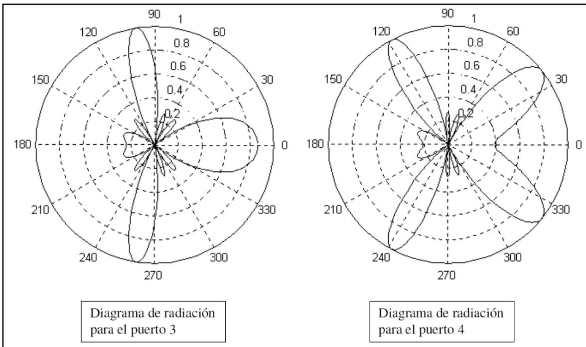
**Fig. 2.4:** Diagramas de radiación de cada puerto.
