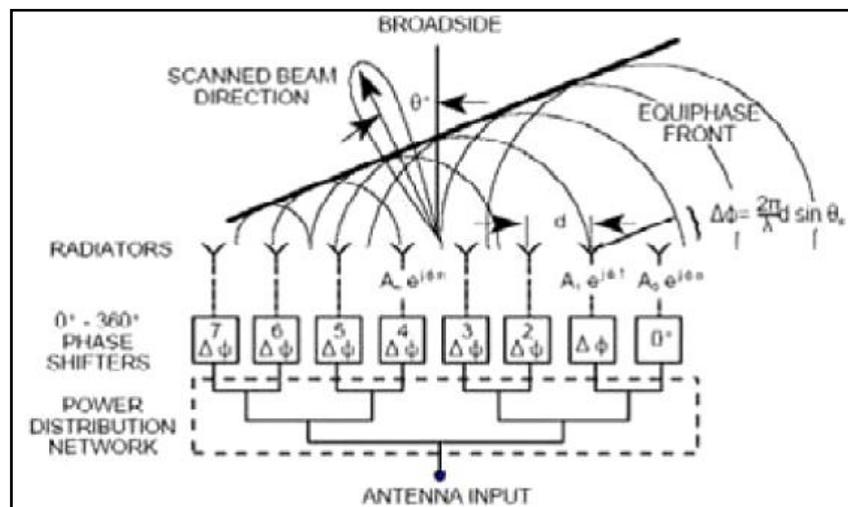
**Fig.4.7 Representación de un Arreglo de fase lineal**
