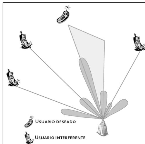
**Figura 2.23: Antena de Haz Adaptativo.**
