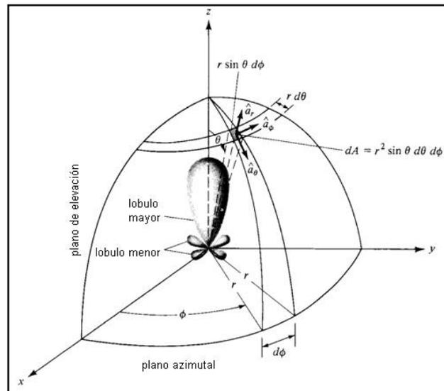
**Fig. 1.6 Sistema de Coordenadas para el análisis de antenas.**
