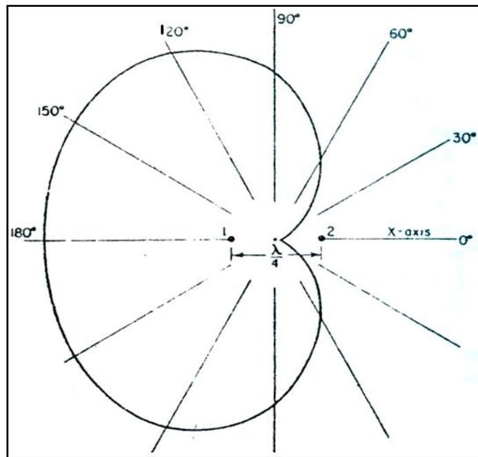
**Fig. 4.12 Radiación de 2 antenas isotrópicas defasadas 45°,  $d = \frac{1}{4} \lambda$ .**
