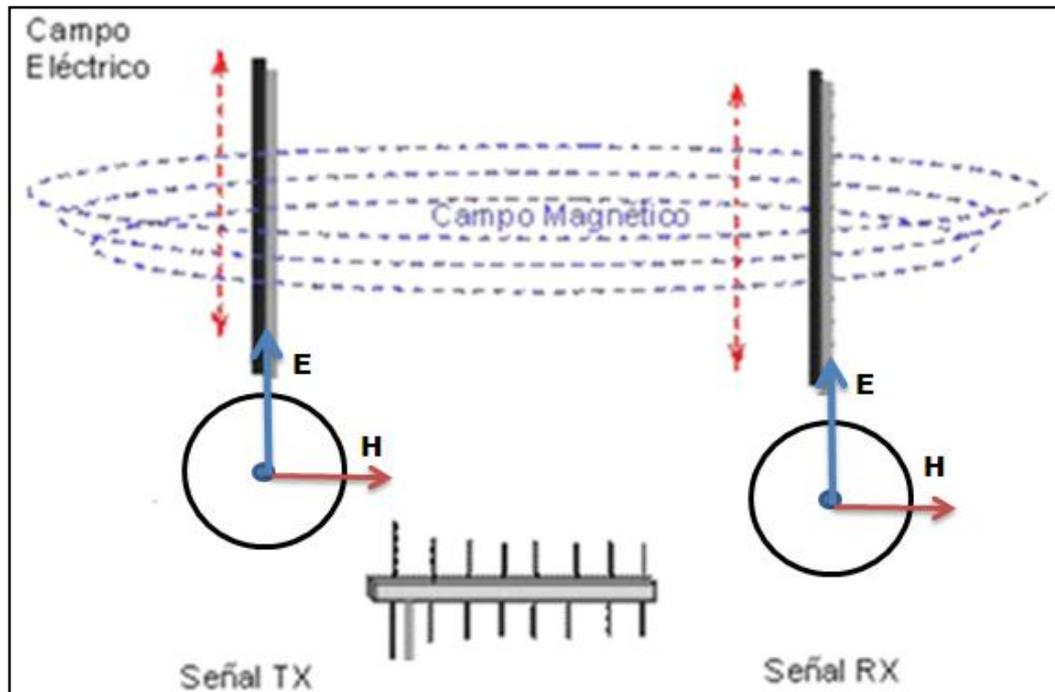
**Fig. 1.4: Polarización vertical.**
