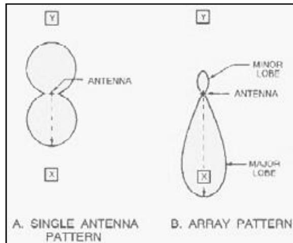
**Fig.4.4 Antena única versus arreglo.**
