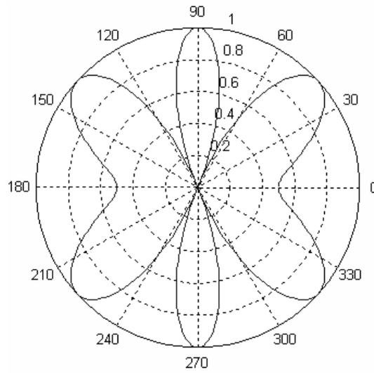
**3.- Patrón de Radiación - Arreglos LES Isotrópico**
