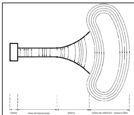
**Fig 1.1: Antena - dispositivo de transmisión.**
