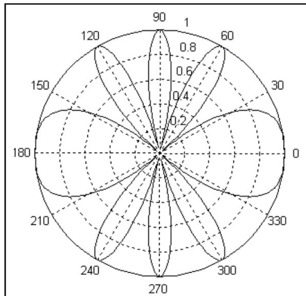
Fig. 4.15 Radiación de 2 antenas isotrópicas,  $d = 2\lambda$ .
