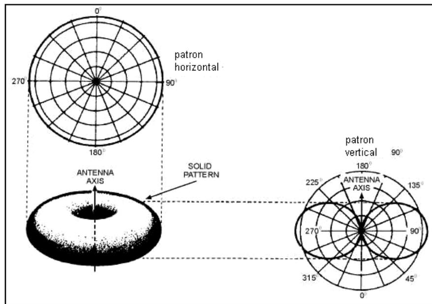
**Fig. 1.12. Patrones de radiación de la Antena Dipolo.**
