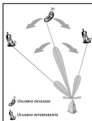
**Figura 2.20: Antena de Haz de Seguimiento.**
