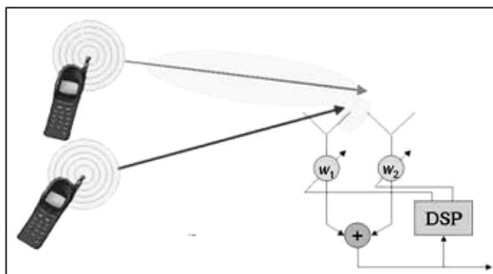
**Figura 2.1. Esquema del entorno de una antena inteligente.**
