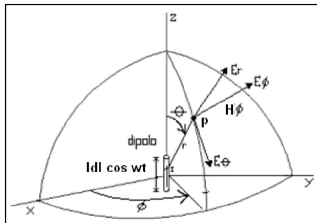
**Fig. 1.14. Dipolo ubicado en el espacio y las componentes de campo en un punto  $p$  de referencia.**
