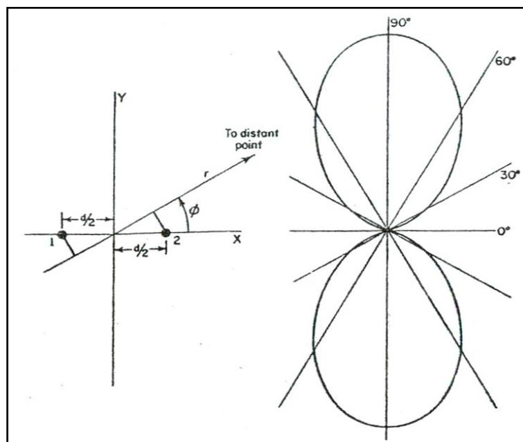
**Fig. 4.9 Sistema de dos antenas isotrópicas.**
