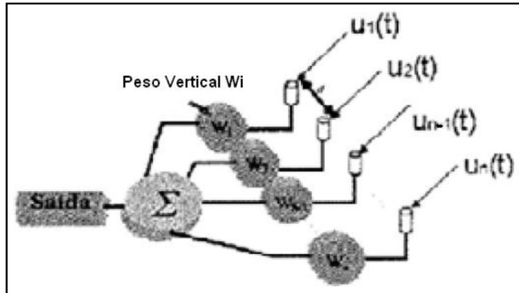
**Fig.4.8 Concepto de un arreglo adaptativo.**
