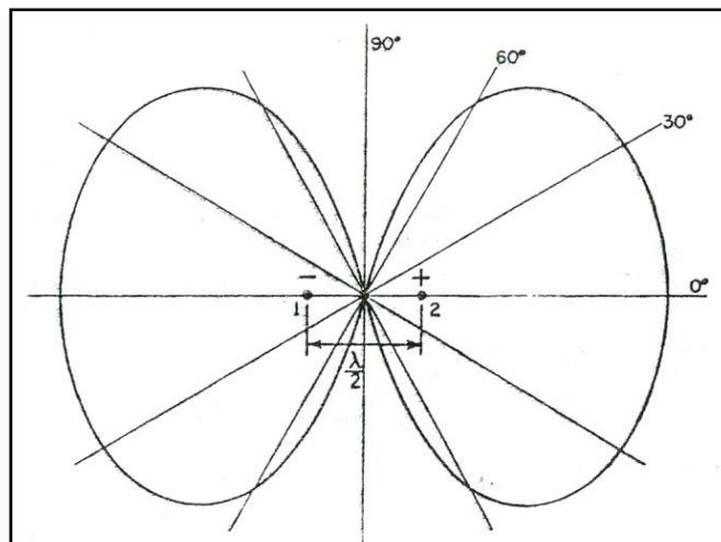
**Fig. 4.10 Radiación de 2 antenas isotrópicas defasadas.**
