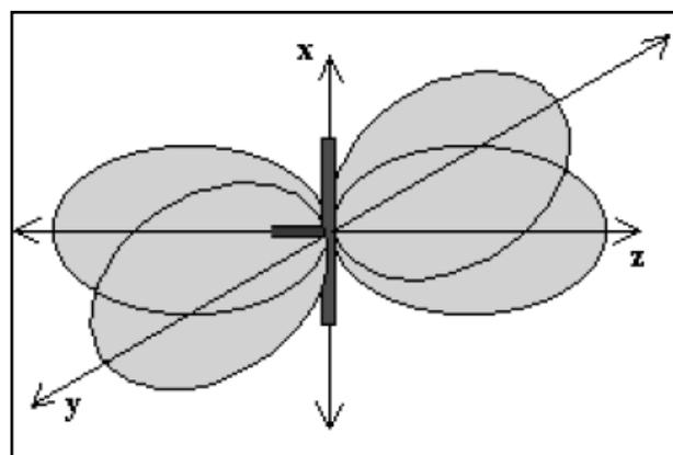
**Fig. 1.11. Radiación de la Antena Dipolo.**
