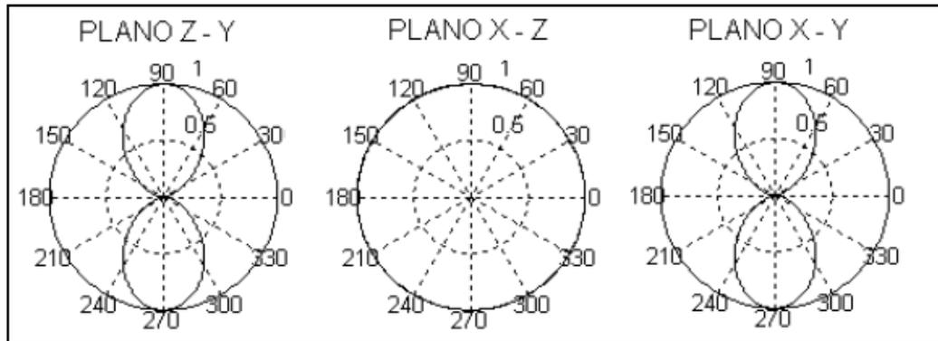
Fig. 4.18 Diagrama de 2 antenas isotrópicas sobre el eje  $x-z$ .
