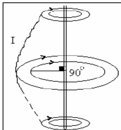
**Fig 1.2: Campos magnéticos creados por la corriente que circula en un elemento metálico.**
