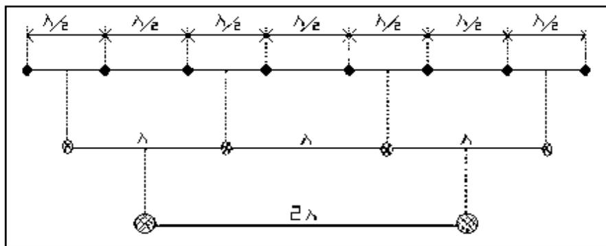
Fig. 4.13 Arreglo de 8 elementos isotrópicos en condición *broadside*.
