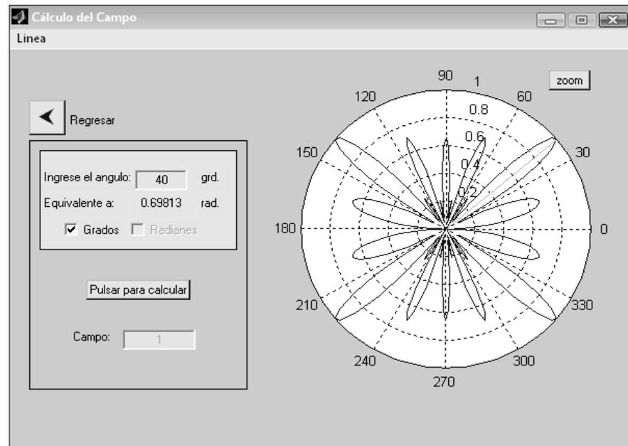
**Fig. 6.7:** Pantalla para el cálculo del valor del campo a un cierto ángulo.
