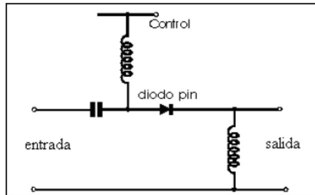
**Figura 2.15. Switch de microonda.**
