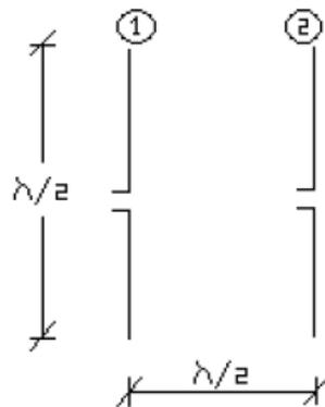
**Fig. 4.16** Array de 2 antenas isotrópicas,  $d = 2\lambda$ .
