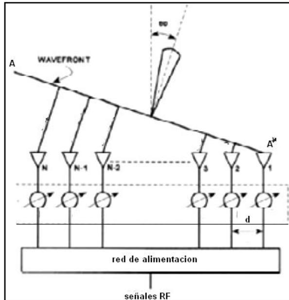
**Fig.4.6 Antena única vs. Arreglo.**
