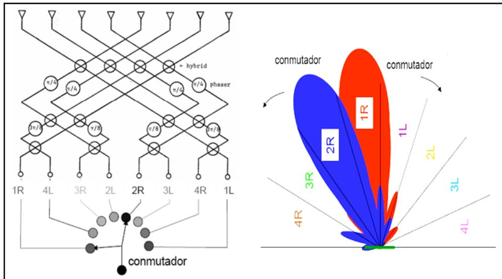
**Figura 2.19: Representación de un Antena de Haz Conmutado:**
