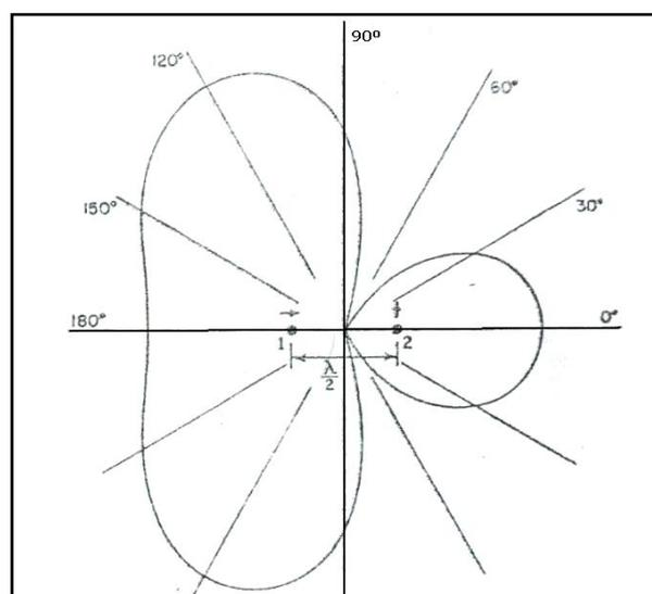
**Fig. 4.11 Radiación de 2 antenas isotrópicas defasadas  $45^\circ$ .**
