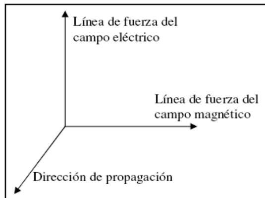
**Fig 1.3: Dirección de campos magnéticos, eléctrico y de propagación.**
