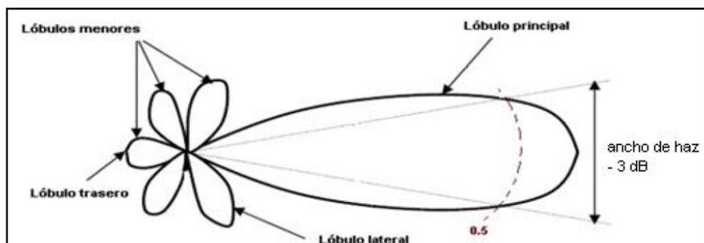
**Fig. 1.9. Lóbulos del diagrama polar.**
