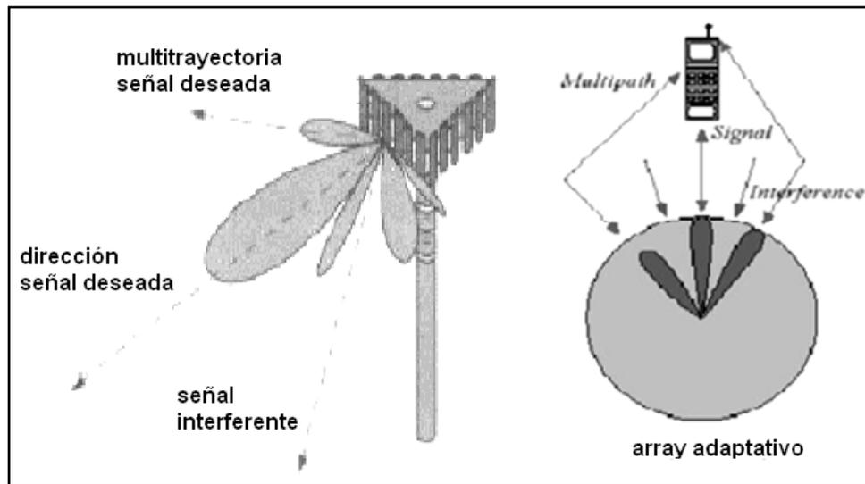
**Fig.4.8.1 Concepto de un arreglo adaptativo.**
