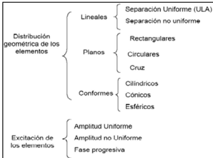
**Fig.4.5 Clasificación de los Arreglos.**
