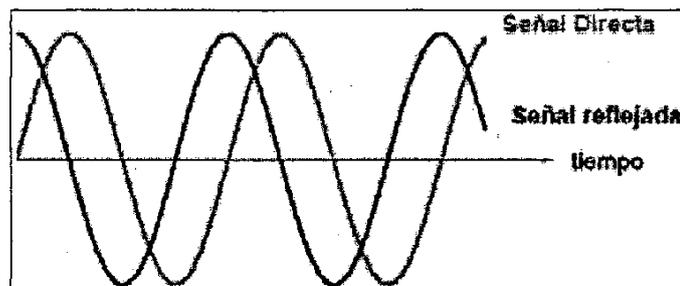
**Fig. 3.4. Problemas en Señales de Multitrayecto.**
