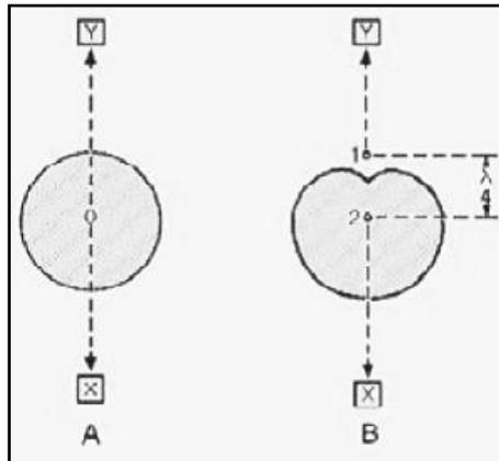
**Fig.4.1.2 Posición en fase de la antena en el espacio.**
