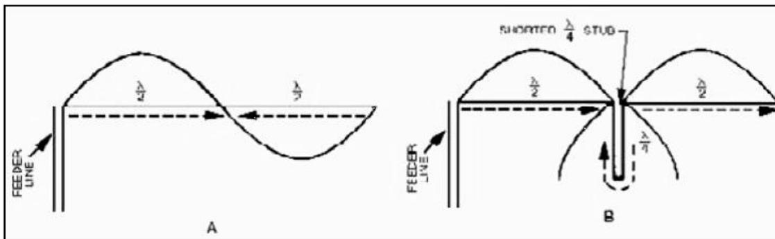
**Fig.4.2 Posición en fase de elementos conectados.**
