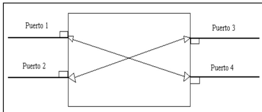
**Figura 2.13. Acoplador Direccional.**
