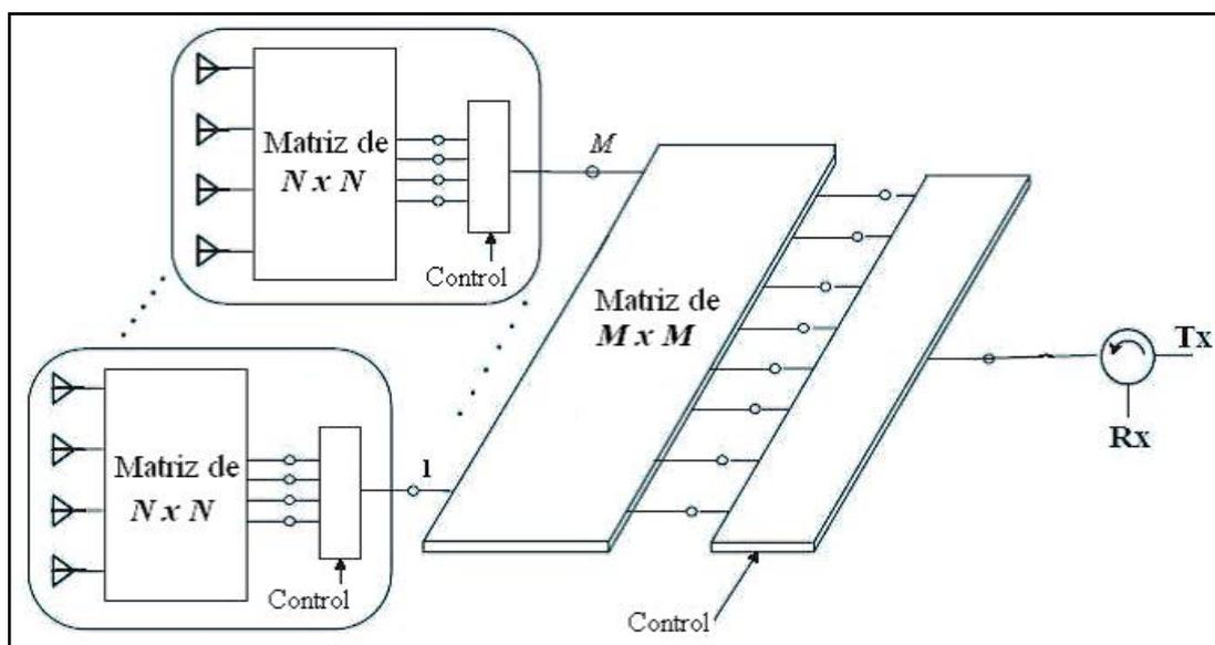
**Figura 2.17. Configuración – Haz Conmutado.**
