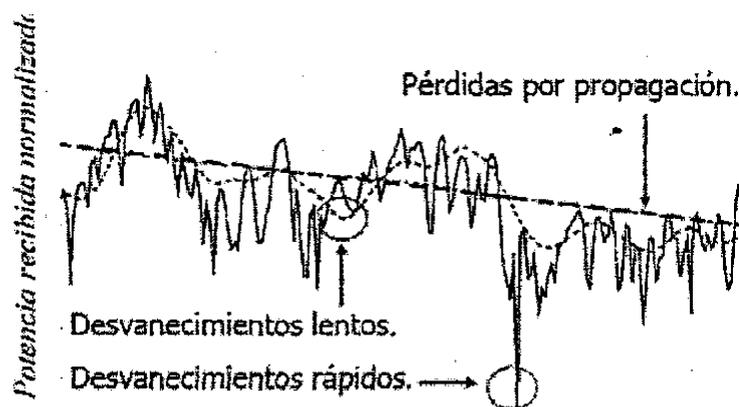
Fig. 3.2.1 Componentes del modelo de canal radio
