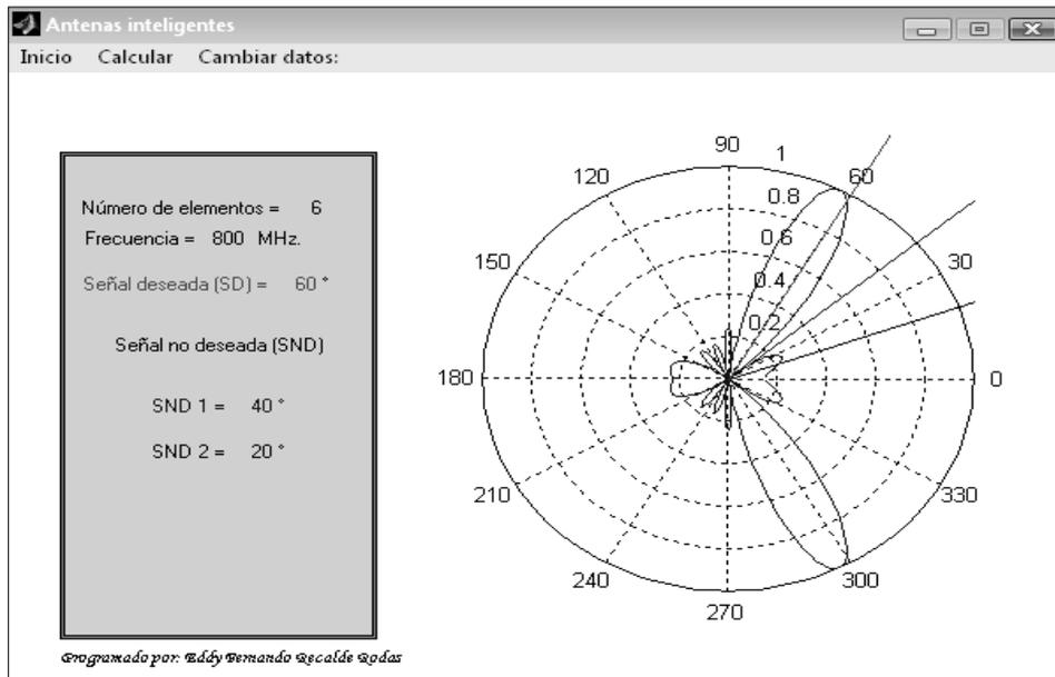
**Fig. 6.18. Pantalla de respuesta – antenas adaptativas.**
