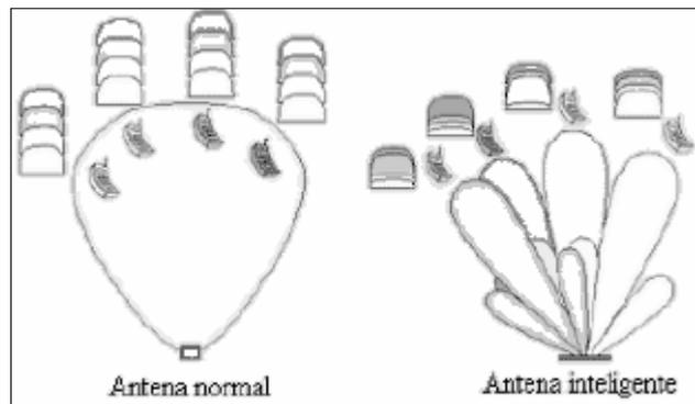
**Figura 2.11 Diagrama de antena normal e inteligente**
