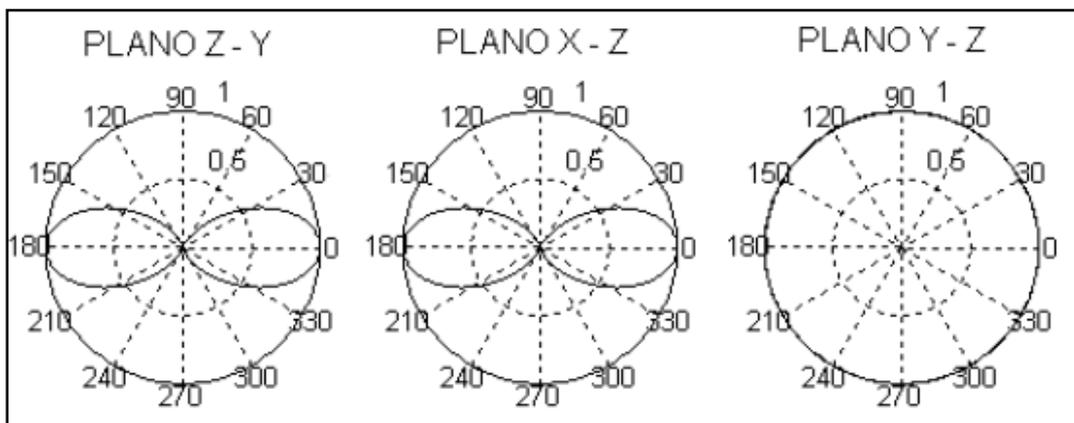
Fig. 4.17 Diagrama de 2 antenas isotrópicas sobre el eje z.
