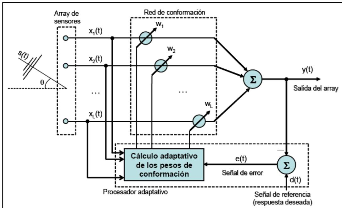
Figura 2.24: Sistema de arreglo Adaptativo.
