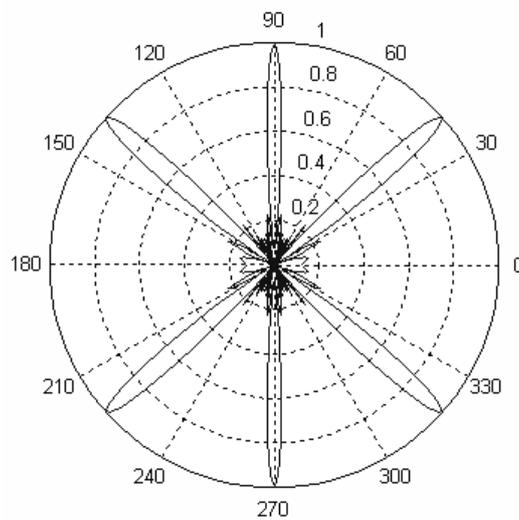
**4.- Patrón de Radiación - Arreglos LES Isotrópico**
