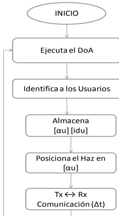
**Figura 2.21: Diagrama de control – Haz de Seguimiento.**
