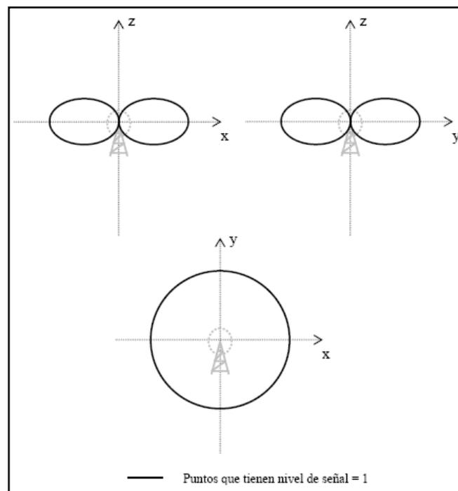
**Fig 1.17: Antena omnidireccional real.**
