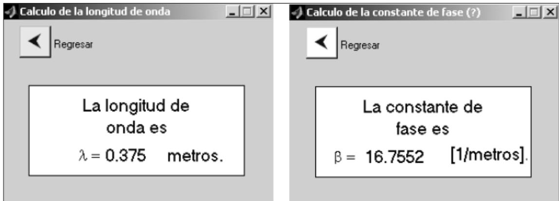
Fig. 6.7.1: Pantalla para el cálculo del valor de  $\lambda$  y  $\beta$ .
