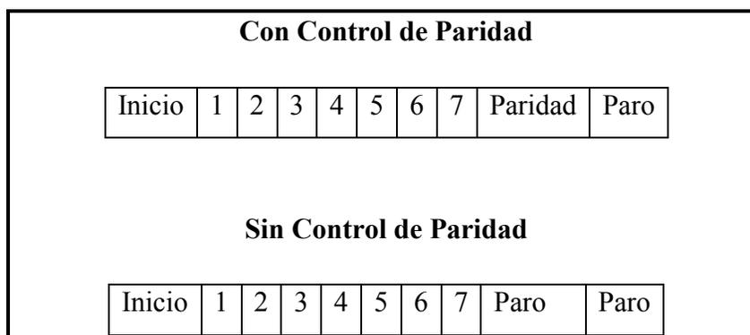
Figura 25: Orden de *bits* en una trama ASCII
