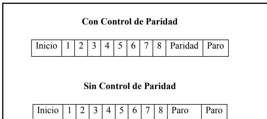
Figura 26: Orden de *bits* en una trama RTU
