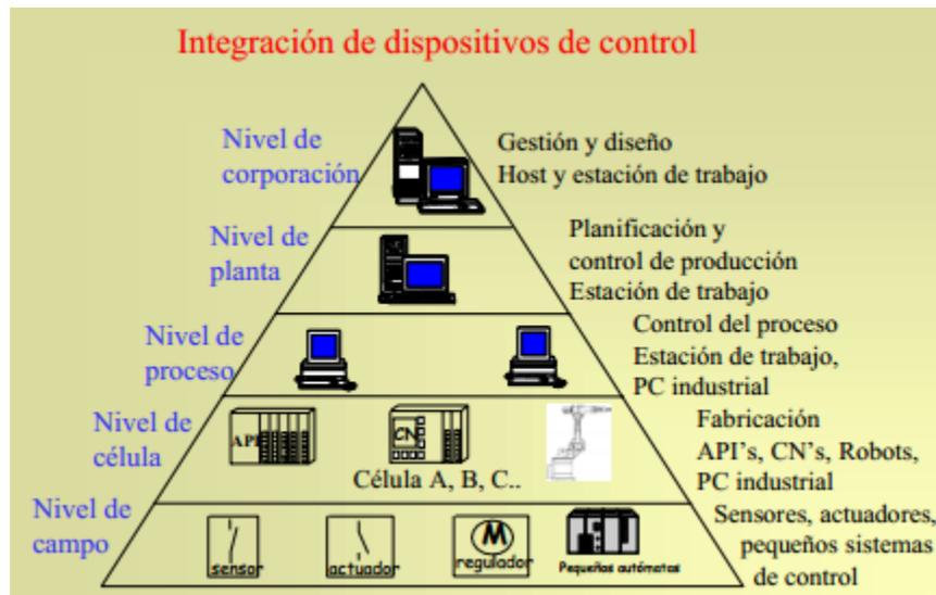
Figura 1: Estructura jerárquica de una red de comunicación industrial [2]
