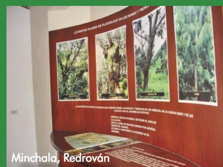
La tipografía es impresa sobre papel adhesivo en un ploter de corte y pegada sobre la superficie sobre las láminas MDF. La infografía es resuelta de la misma manera.
