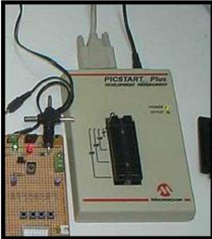
**Figura 1.4.** Programador semi industrial para micro controladores.
