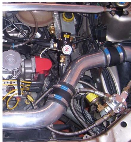
Sistema sobrealimentador en el motor
