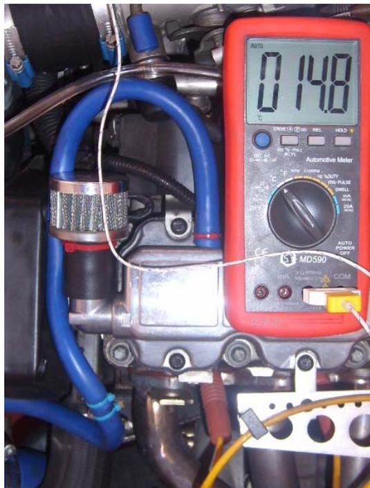
Temperatura a la salida del Intercooler
