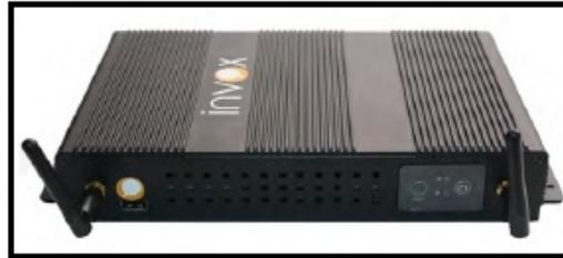
**Figura 3.8** Modulador receptor de micrófono inalámbrico
