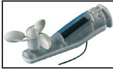
**Figura 3.7** Anemómetro y sensor de radiación
