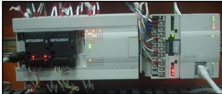
Figura 7.1: PLC Mitsubishi FX-3G, Módulo Analógico de Adquisición de Temperatura, Módulo Ethernet.
