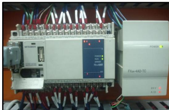
Figura 7.2: PLC Mitsubishi FX-1N, Módulo Analógico de Adquisición de Temperatura.
