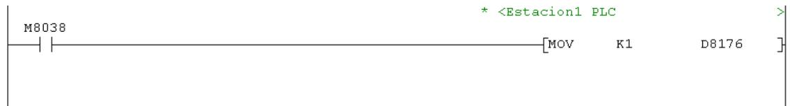
Figura 5.23: Configuración de Estación Esclavo.
