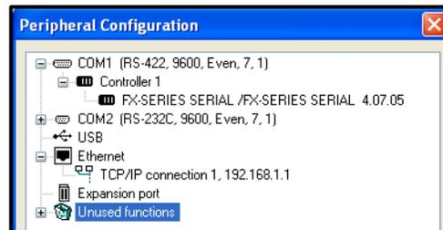
Figura 5.2: Controlador para la conexión con el PLC.
