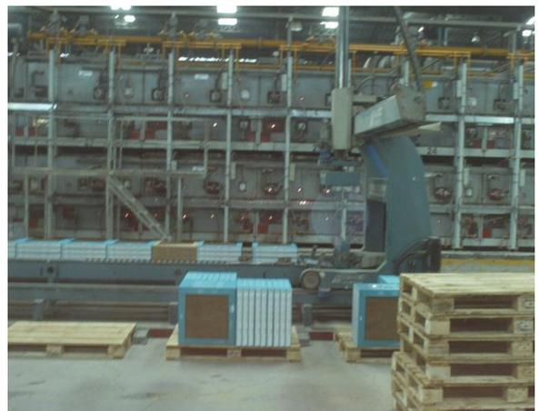
**18. Luego la máquina coloca las cajas en los pallets.**
