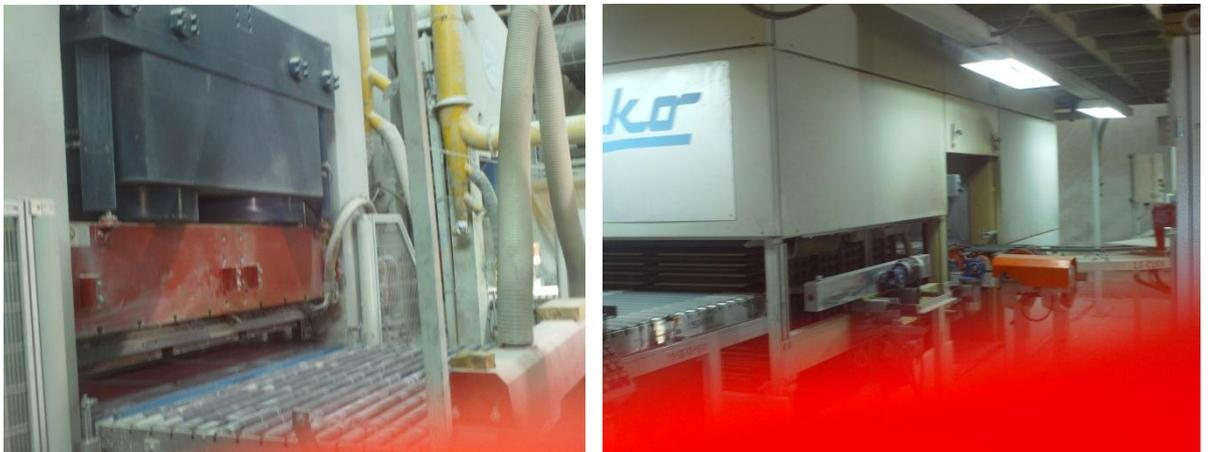
10. Posteriormente los bizcochos pasan al secadero en donde se extrae la humedad residual que pueda existir de las piezas prensadas.
