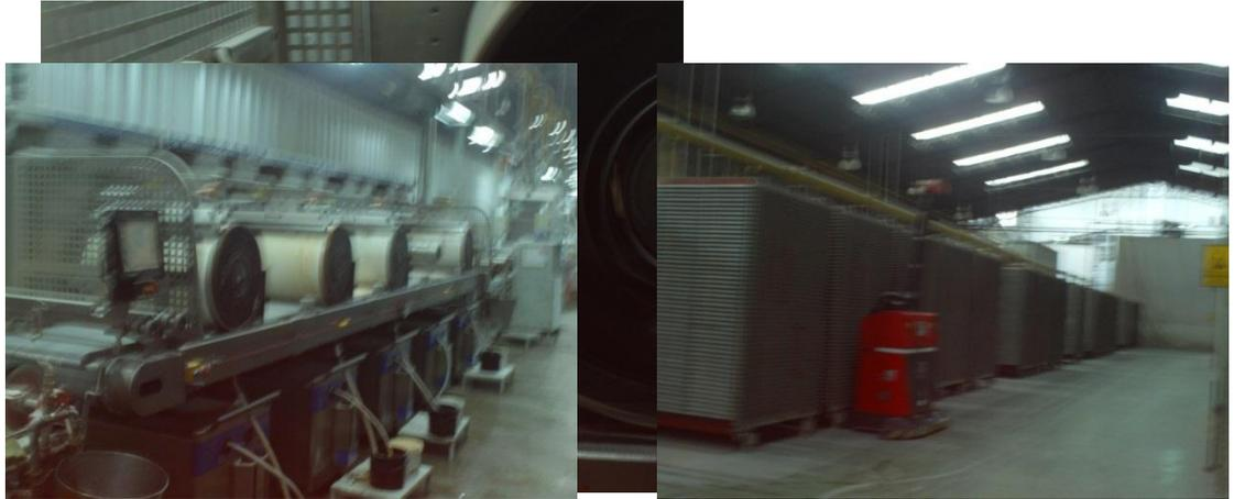
13. Luego que el material haya pasado los procesos anteriores se va a almacenar en los box de carga. Aquí se almacena antes de que envíen al horno. Siempre queda almacenado por lo menos para 15 días de producción debido a que el horno nunca deja de funcionar. Aquí podemos apreciar la tecnología de punta que manejan ya que estos box son llevados por robots que son dirigidos a base de sensores.
