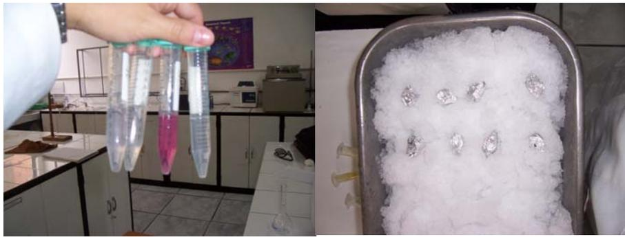
**Figura 15:** Soluciones de extracto y soluciones finales, con los reactivos correspondientes; listas para se leídas en el espectrofotómetro.
