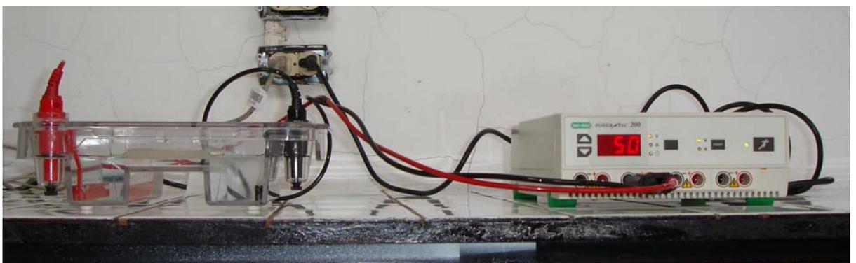
**Figura 22:** Equipo de electroforesis (cama y fuente de energía)
