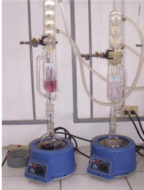
**Figura 10:** Aparato de soxhlet, cargado con los cartuchos de maíz morado
