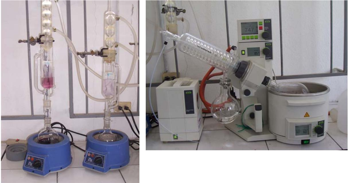
**Figura 21:** Aparato de Soxhlet y rotavapor utilizados en la extracción de pigmentos para la determinación de la actividad antioxidante.
