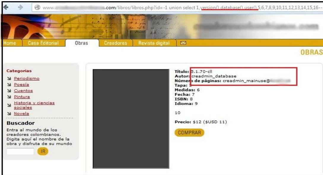
Figura 7.33 Visualización de Datos del Gestor– Web Analizada.
