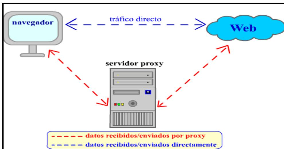
**Figura 8.1 Funcionamiento de un servidor proxy.** (<http://www.telypc.com> , Parr 2)
