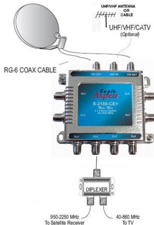
Figura 2.3.1 Multiswitch Aspen para banda C Y banda KU
