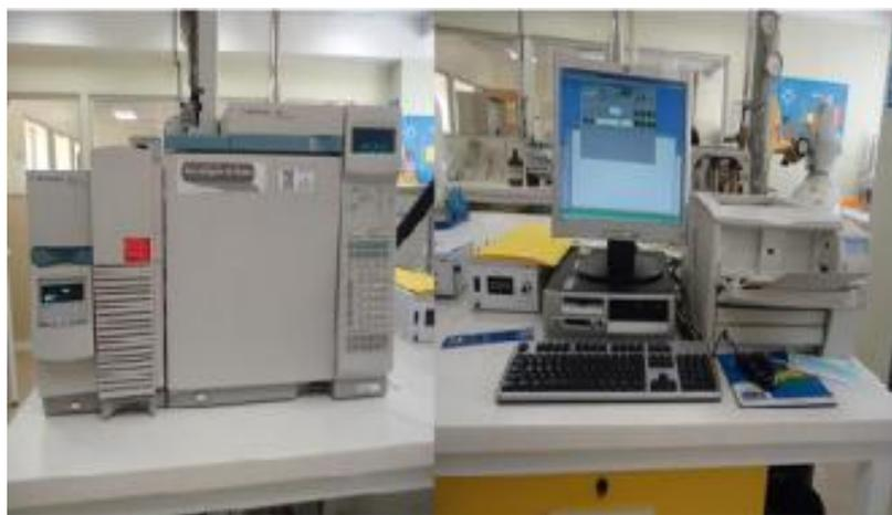
Figura 2.6.1: Cromatógrafo de Gases Agilent 6890N
