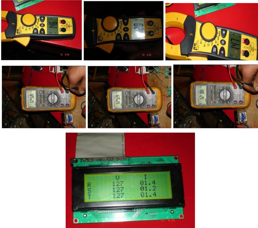
Figura 4. 4 Comparación de voltaje y corriente con una carga de 0,kW
