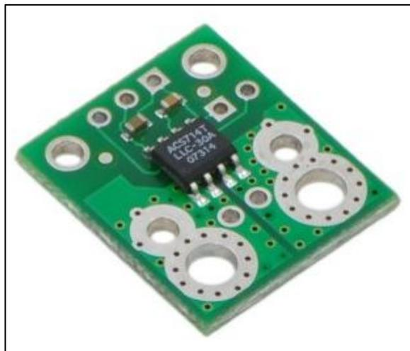
**Figura 2. 21** Tarjeta del sensor de corriente ACS714
