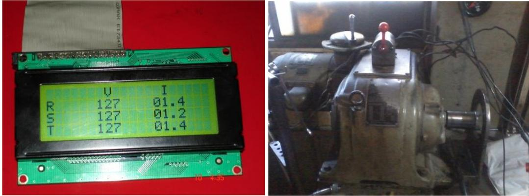
Figura 4. 1 Medición de voltaje y corriente con carga de 0,746kW
