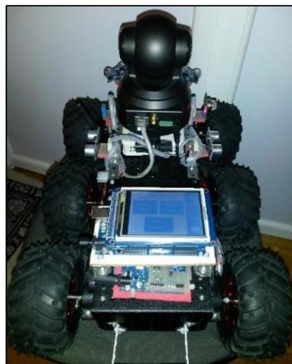
Figura 3.46 Vista posterior del robot, donde se aprecia pantalla LCD.
