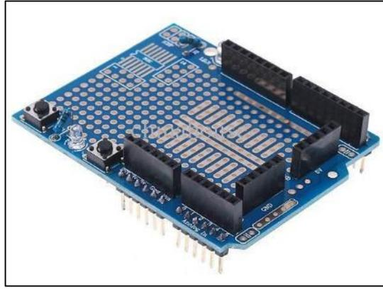
Figura 3.6 *Shield* Genérico para Arduino.
