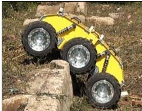
Figura 1.8 Robot experimental para túneles de minería (*National Robotics Engineering Center*).
