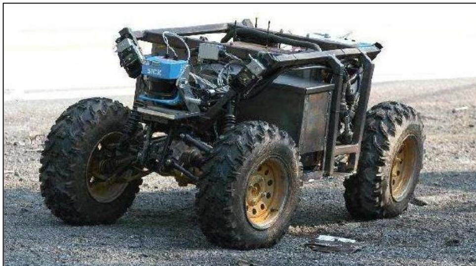
Figura 1.9 Robot *Groundhog* para mapeo de minas (6).
