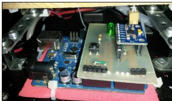
Figura 3.37 Ubicación del controlador y giroscopio dentro del robot.
