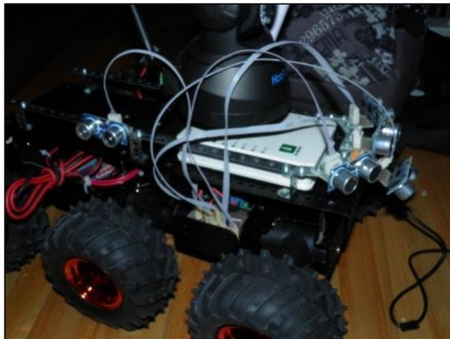
Figura 3.18 Disposición final de los sensores sobre chasis del robot.
