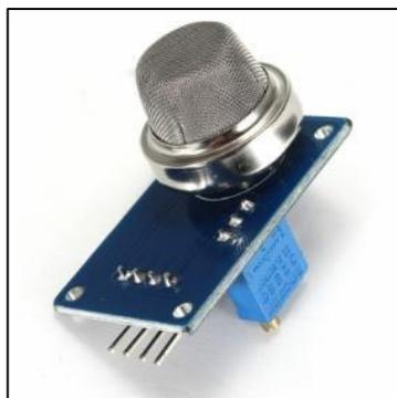
Figura 3.23 Sensor MQ-4 en placa de circuito impreso.
