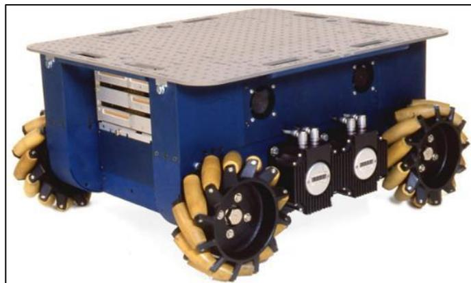
Figura 1.4 Robot Uranus con ruedas omnidireccionales.
