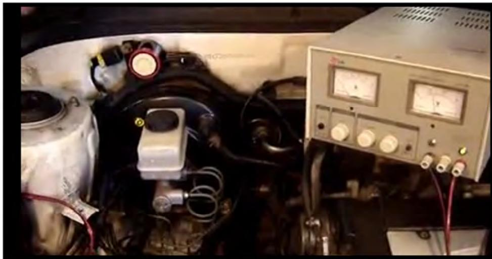
Figura 2.20 Activación de los actuadores por medio de una fuente.
