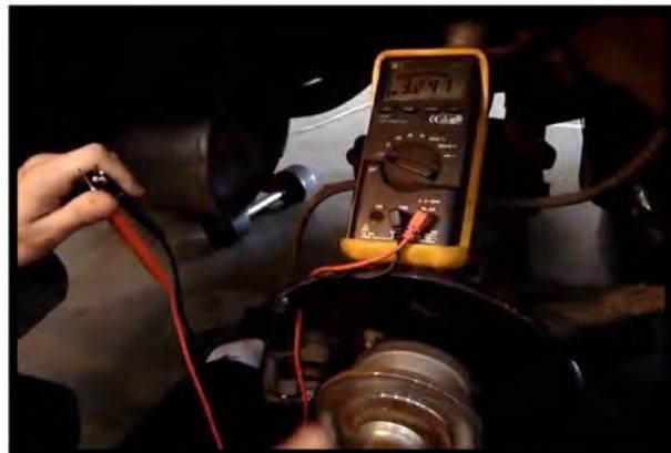
Figura 2.12 Prueba de voltaje sensor de velocidad ABS.
