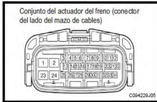
Figura 2.23 Conector del lado del mazo de cable.
