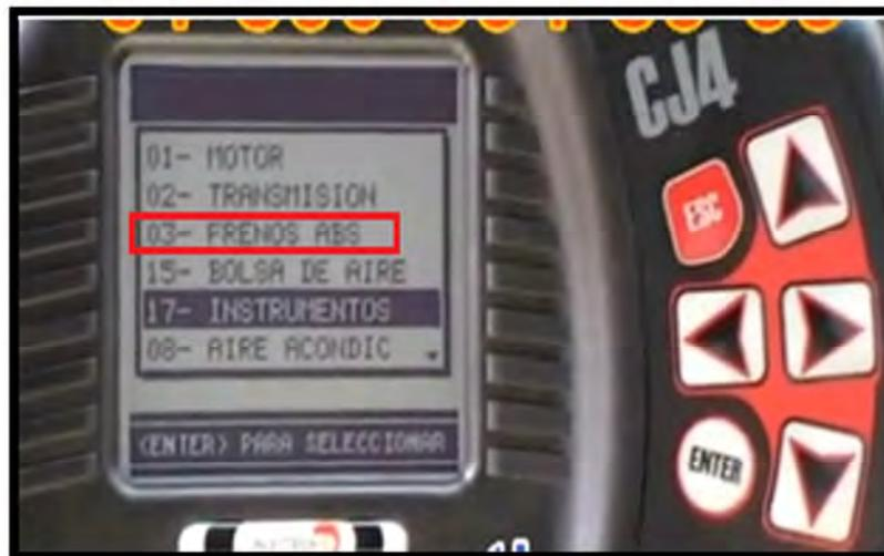
Figura 2.7 Escáner CJ4 (Frenos ABS).
