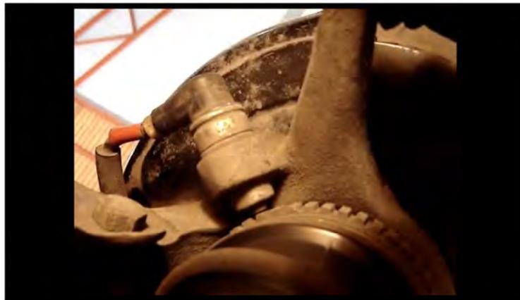
Figura 2.16 Holgura entre sensor y rotor.
