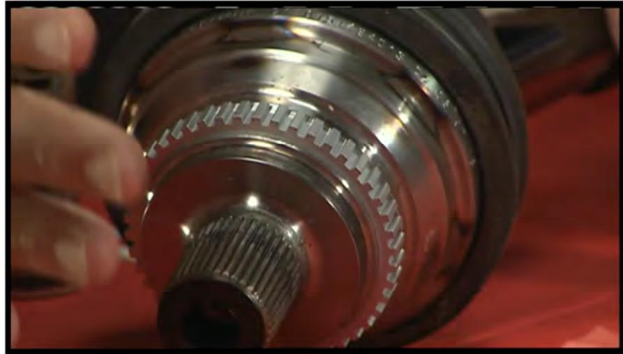
Figura 2.17 Estado de los dientes del rotor.
