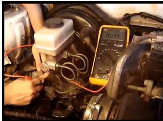
Figura 2.19 Comprobación resistencia electroválvulas.
