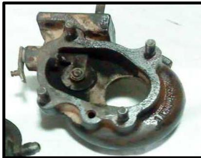
Figura 1.3 Carcasa de Turbina del turbocompresor
