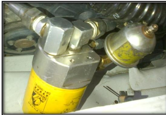
Figura 4.17 Acople para filtro de aceite y cañerías de presión
