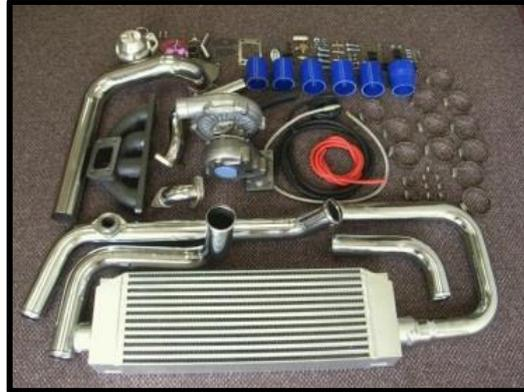
Figura 1.36 Elementos del sistema de admisión.
