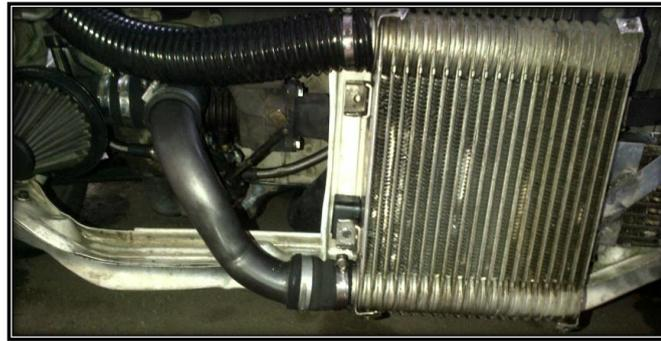
Figura 4.2 Enfriador de aire (Intercooler)
