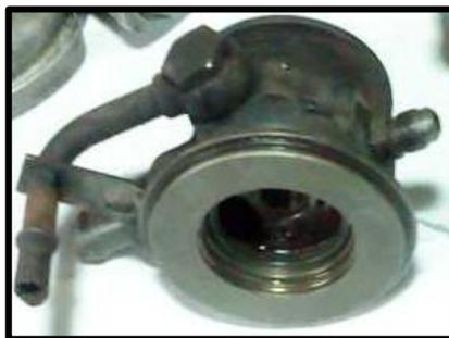
Figura 1.4 Carcasa Central del Turbocompresor
