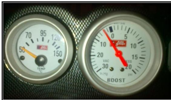
Figura 4.5 Indicadores de temperatura del aceite y presión del sistema sobrealimentado
