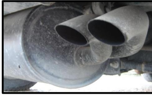
Figura 4.12 Tubo de escape con silenciador
