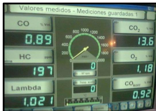
Figura 2.7 Resultados de analizador de gases a 800 rpm
