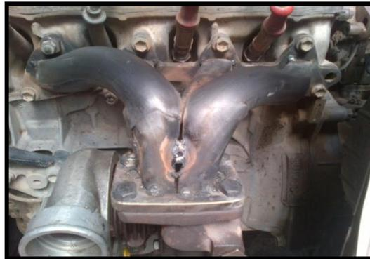
Figura 4.10 Construcción de múltiple de escape y base del turbo
