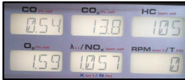
Figura 5.3 Resultados de analizador de gases a 2500 rpm
