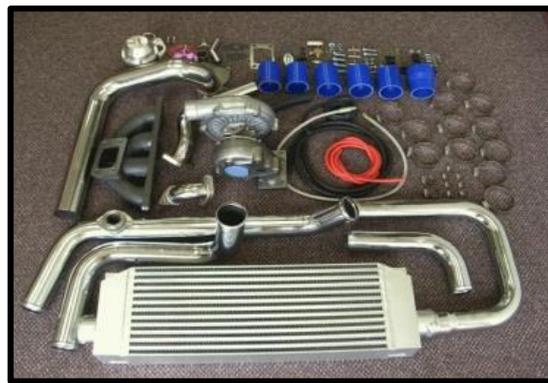
Figura 4.1 Elementos del sistema de Admisión.
