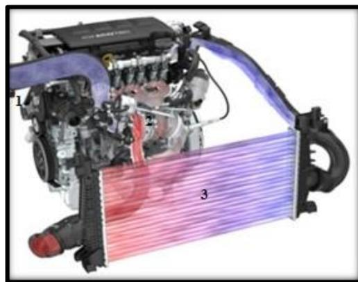
Figura 4.7 Flujo de circulación de aire en sistema de admisión sobrealimentado
