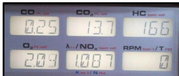
Figura 5.2 Resultados de analizador de gases a 800 rpm
