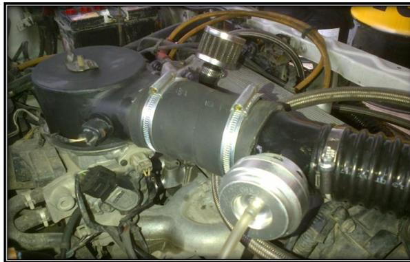
Figura 4.4 Instalación de válvula de alivio (blow off)
