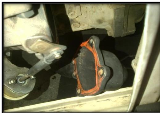
Figura 4.13 Acoplamiento del tubo de escape al turbo
