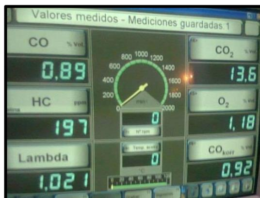
Figura 2.8 Resultados de analizador de gases a 800 rpm
