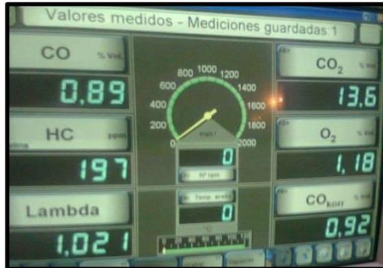
Figura 2.6 Resultados de analizador de gases a 800 rpm
