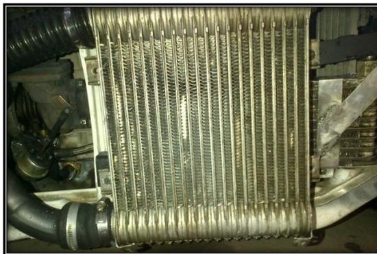
Figura 4.18 Ubicación de radiador de aceite en sistema de sobrealimentación
