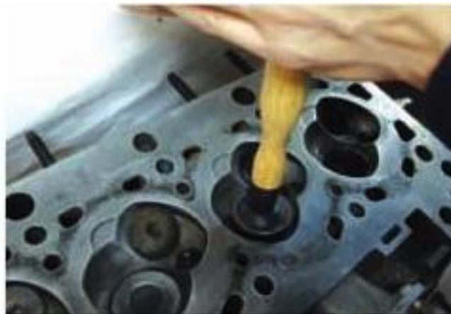
Figura 1.13 Esmerilado manual de los asientos de válvulas.
