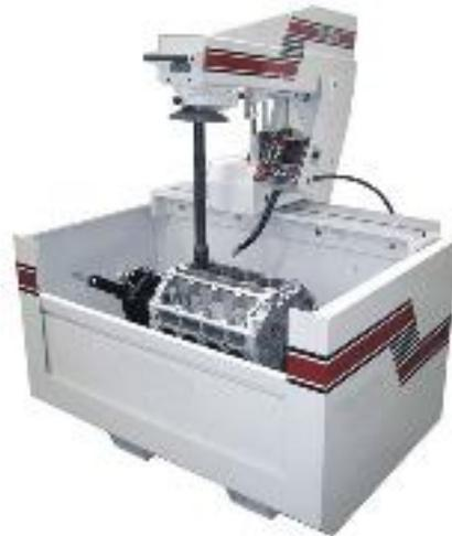
Figura 1.16 Máquina rectificadora de cilindros.
