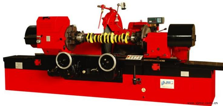
Figura 1.18 Máquina rectificadora de muñones del cigüeñal.
