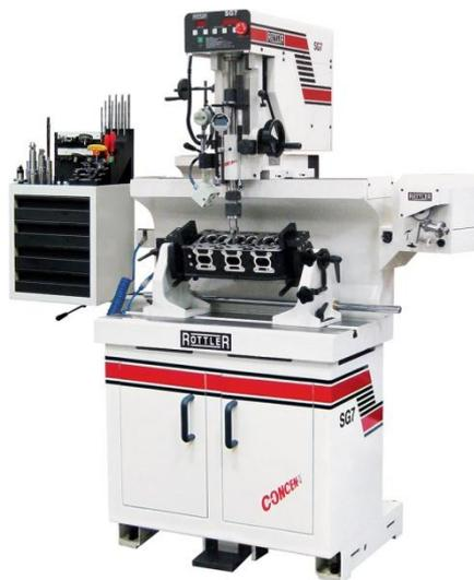
Figura 1.15 Máquina rectificadora de asientos de válvulas.
