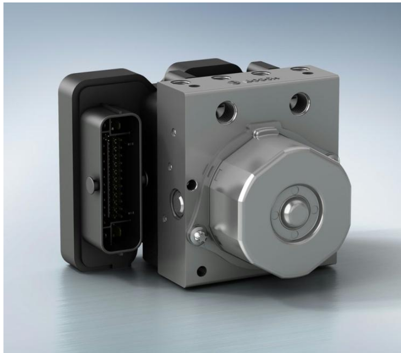
Figura 2.4 Grupo hidráulico y unidad de control integrada.
