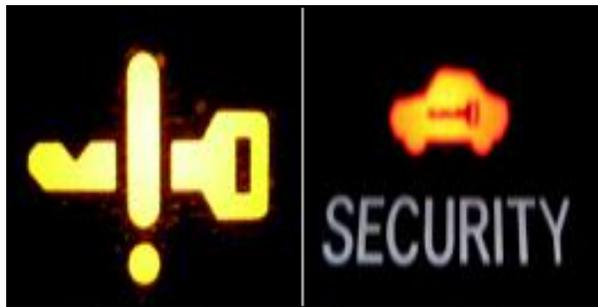
Figura N° 3.3 Luz de seguridad de llave, tablero de mandos
