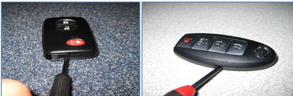
Figura N° 3.7 Proceso para cambio de batería
