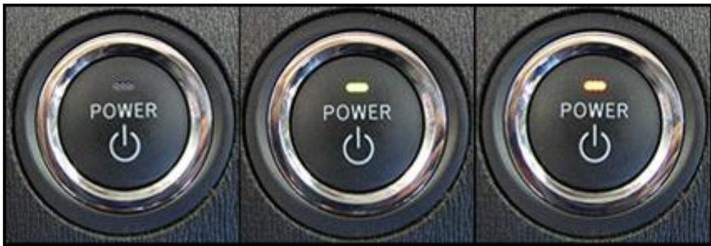
Figura N° 1.10 Interruptor de encendido - Toyota Prius
