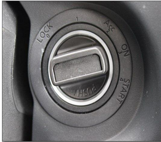
Figura N° 1.11 Interruptor de encendido - Nissan Armada
