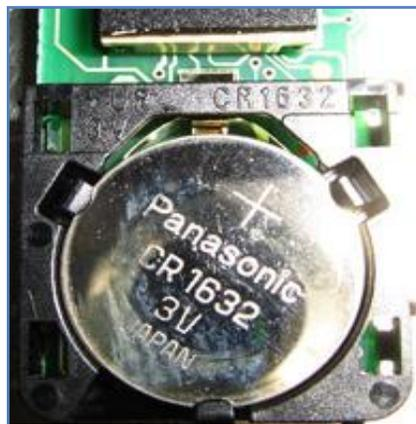
Figura N° 1.5 Batería de mando remoto
