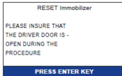
A pesar de que en la pantalla se muestre reseteo del inmovilizador, en realidad estamos reiniciando las funciones de entrada remota sin llaves.
