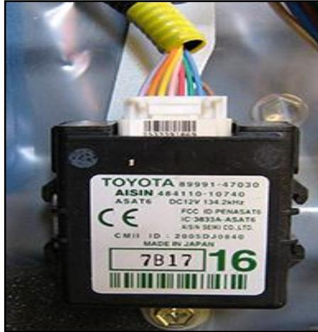
Figura N° 1.7 Oscilador externo de puerta
