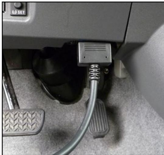
La “ranura de aprendizaje” está ubicada en el lado derecho del conductor en el tablero de control
