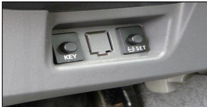
Los modelos con el sistema de acceso de proximidad inteligente tienen un botón "Lock-Out" en la parte inferior del tablero de instrumentos, debajo de la dirección la columna. Asegúrese de que el botón está en la posición "Out" (no presionado).
