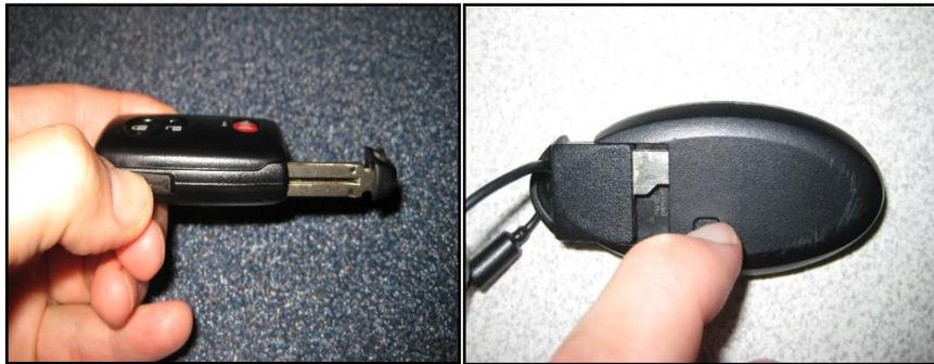
Figura N° 3.6 Llave mecánica en el mando remoto
