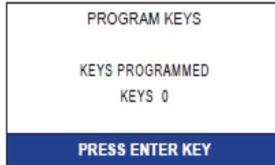
El reinicio de la ECU fue completado exitosamente si en la pantalla se muestra (llaves programadas KEYS 0)
