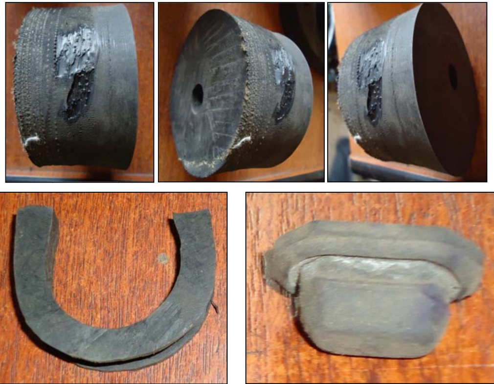
Figura 2.12 Elaboración de repuestos de vehículos, elementos, y figuras utilizando neumáticos radiales.
