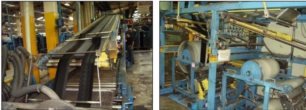
Figura 1.17 Transporte final de laterales, y almacenaje de cartuchos de cinta (cassettes).
