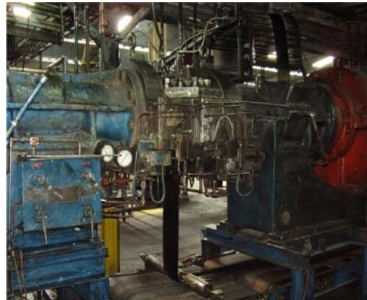
Figura 1.14 Armado de implementos para la extrusión de las llantas.
