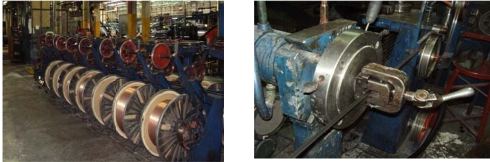
Figura 1.21 Rollos de alambre para el proceso de pestañas, aislamiento y recubrimiento del alambre con caucho.
