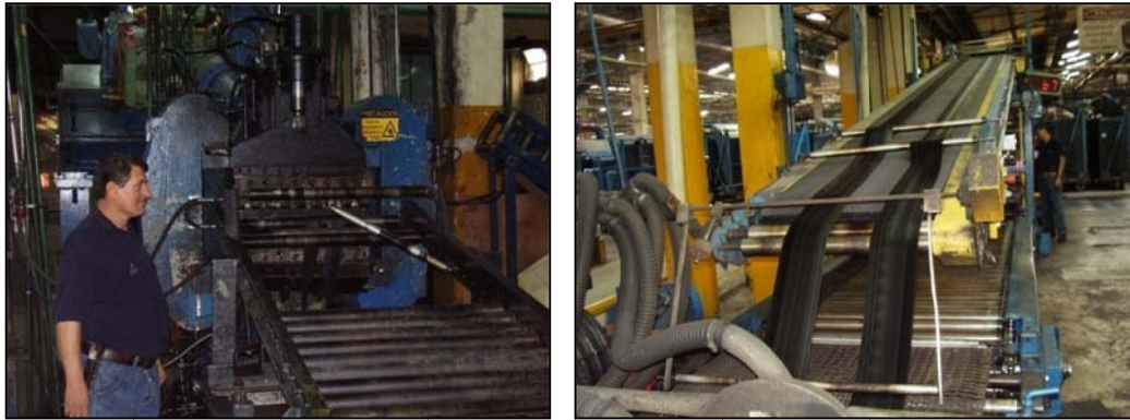
Figura 1.16 Extrusión lateral, y laterales obtenidos después del proceso de enfriado.
