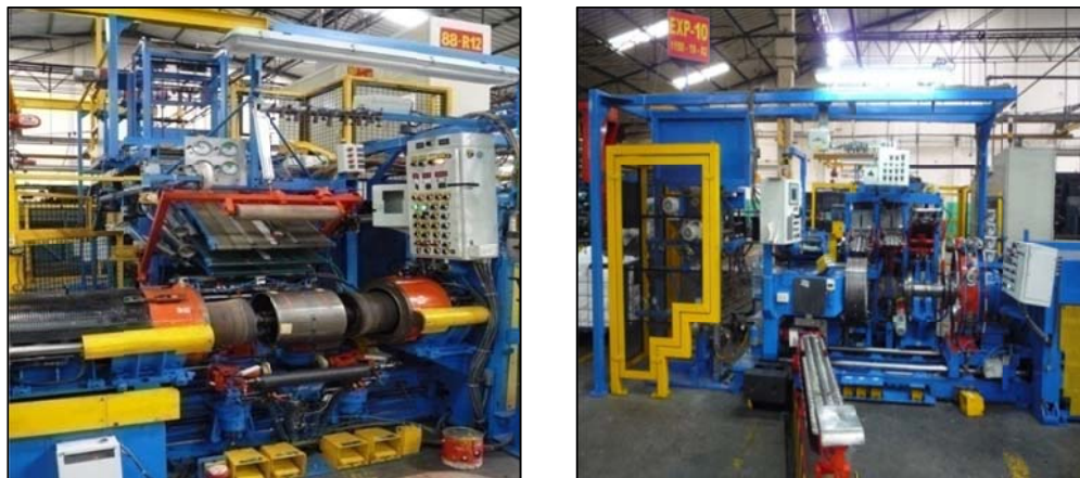
Figura 1.24 Máquinas nuevas adquiridas para la construcción de primera y segunda etapa radial PLT.
