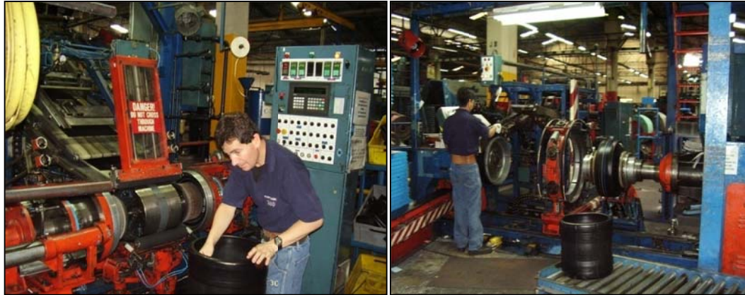
Figura 1.23 Construcción de primera y segunda etapa radial PLT.
