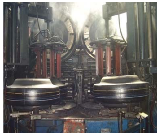
Figura 1.27 Proceso de vulcanización de llantas etapa 2.
