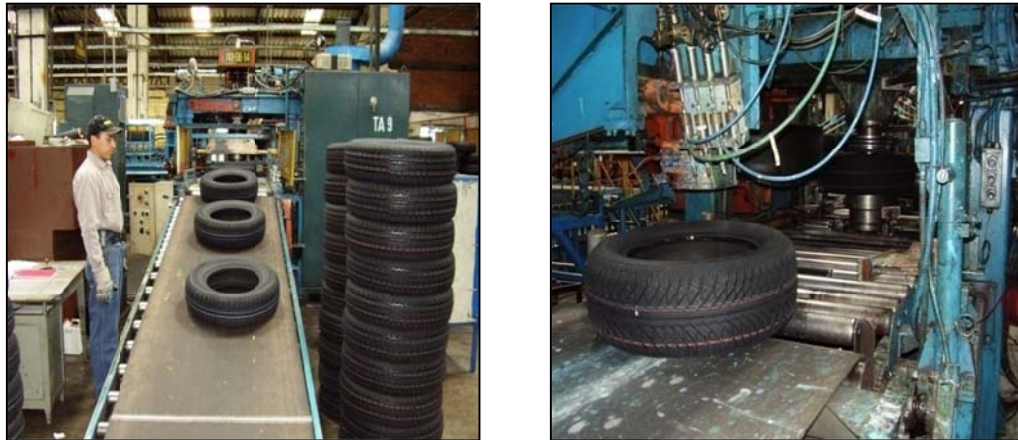
Figura 1.29 Máquina de ensayos de uniformidad, pruebas de fuerzas radiales, laterales, conicidad, y geometría de las llantas.
