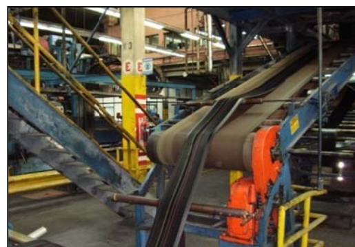
Figura 1.15 Líneas de identificación del rodamiento y rodamiento obtenido después del proceso de enfriado.
