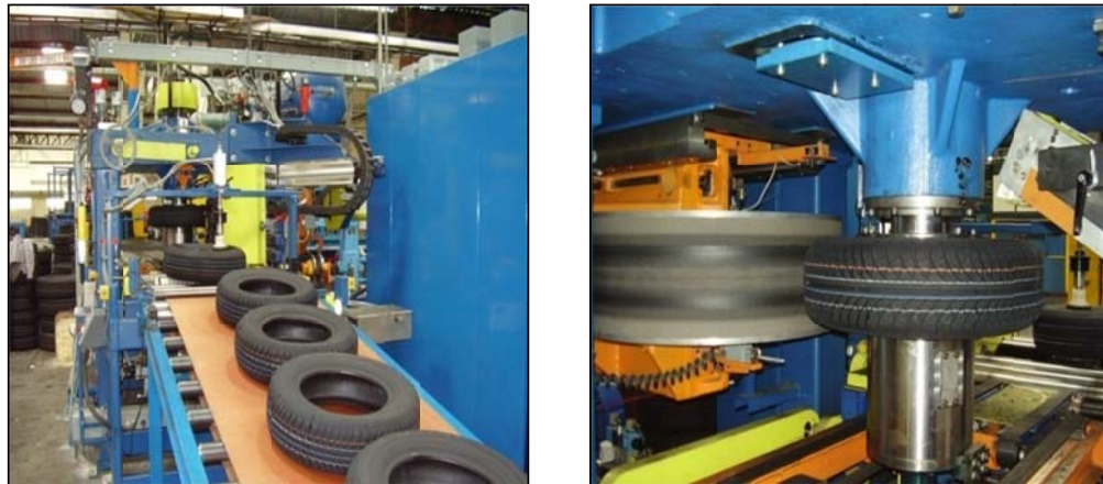
Figura 1.30 Máquina de ensayos de uniformidad, Pruebas de fuerzas radiales, laterales, conicidad, y geometría de las llantas.
