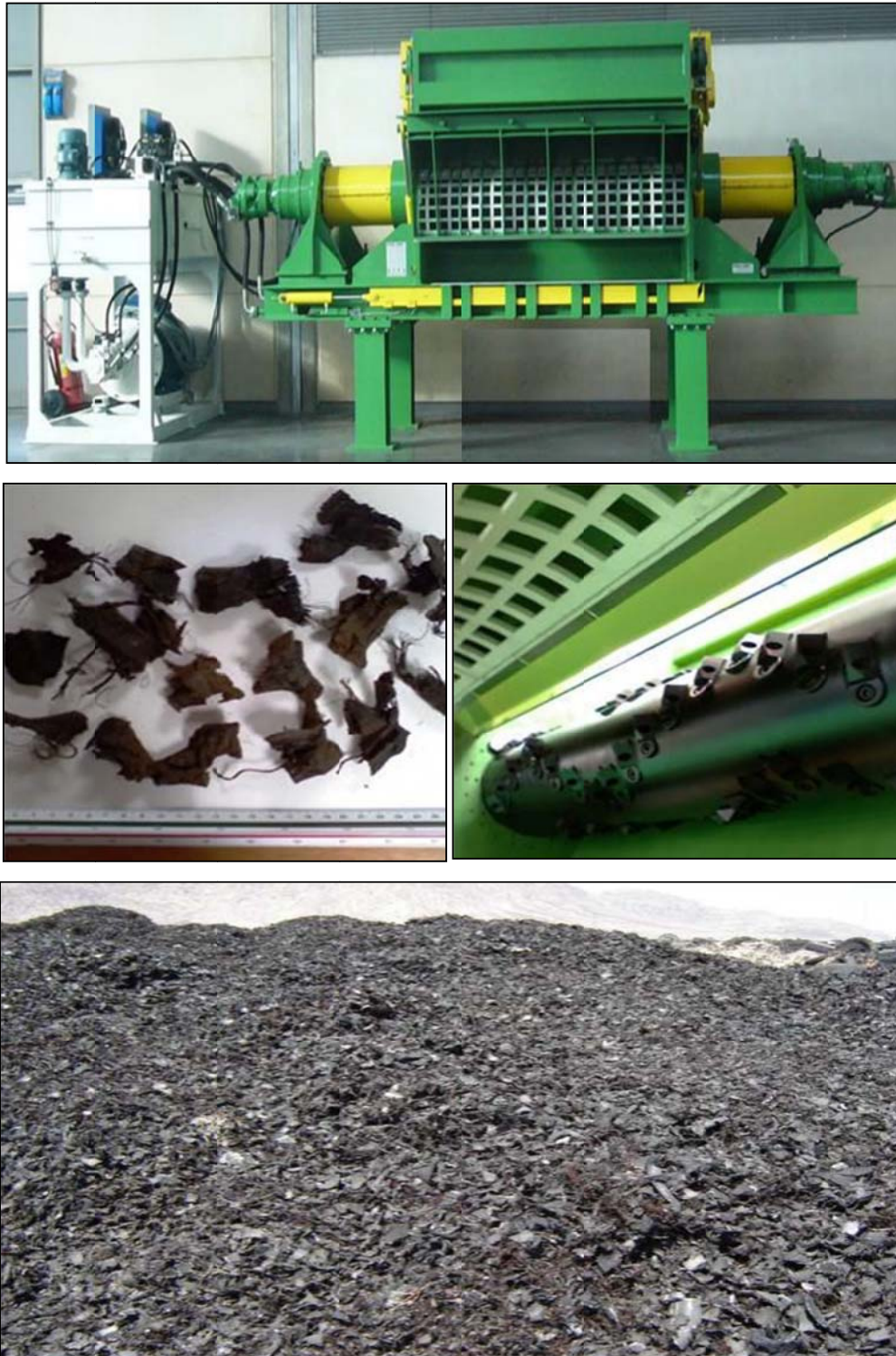
Figura 3.7 Material obtenido en proceso de trituración.
