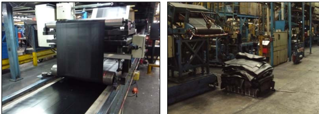
Figura 1.18 Cabezal de rodillo (Rolled Head) en proceso de fabricación de paredes interiores (Inner Linner).
