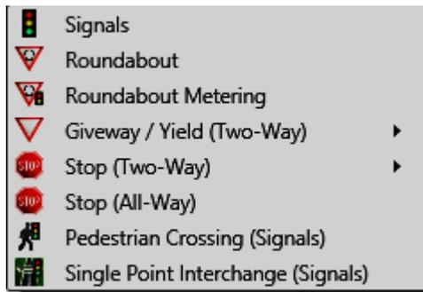
Figura 70: Cuadro de dialogo tipo de intersecciones (Fuente: Sidra Intersection 5.1)
