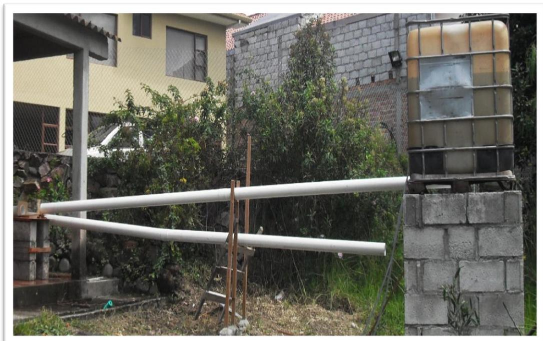
La tubería de conducción usada para la realización de las pruebas es de un diámetro de 110mm, la cual se coloca desde la salida del tanque hasta el punto donde se colocará el derivador, dicha tubería se encuentra con pendiente de 1% sobre las bases de madera mencionadas anteriormente (Figura 11).
