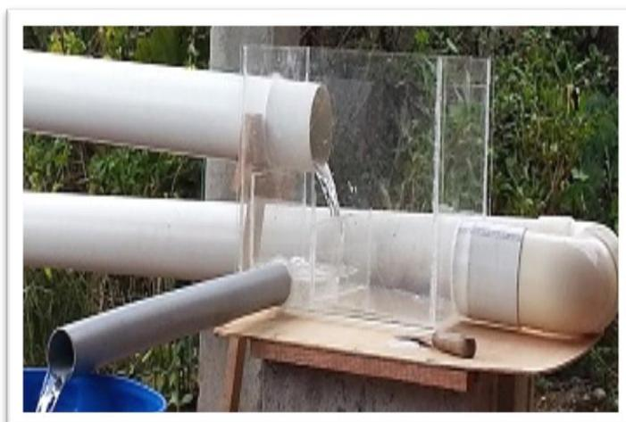
Una vez que el agua retorne al tanque antes mencionado, se procede a pasar el agua de dicho tanque al tanque de distribución con la ayuda de una bomba (Figura 15); concluido el proceso de armado de la maqueta, se puede ya proceder a la toma de datos o lecturas necesarias.
