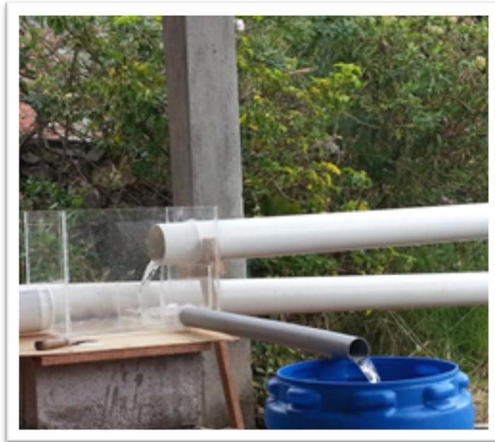
Una vez colocado el derivador con la tubería de ingreso, se coloca una tubería de 50mm de diámetro, la cual conducirá el agua derivada hacia un tanque para poder tomar datos del agua derivada; además existe otra salida mediante una tubería de 110mm la cual conducirá el agua no derivada hacia otro tanque de capacidad de  $1\text{m}^3$ , esto con el fin de poder reutilizar el agua que se conduce (Figura 14).
