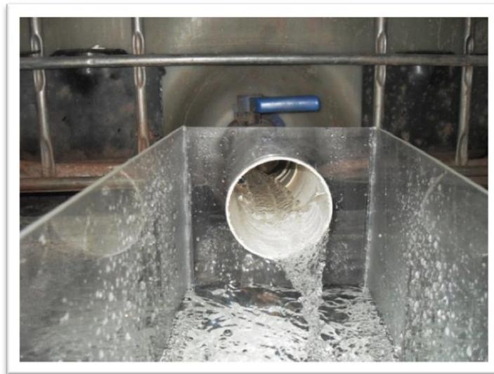
Posteriormente procedemos a construir bases de madera que permitirán sostener la tubería que conducirá el agua hacia el derivador a escala, para ello se tomen niveles desde la salida del tanque de abastecimiento, esto con el fin de poder ir dando la pendiente respectiva a la tubería de conducción. La pendiente dada a la tubería es del 1% (Figura 10).
