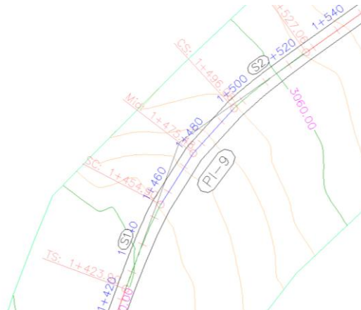
Figura 15 Etiquetado de las intersecciones de tangentes en la curva espiral
