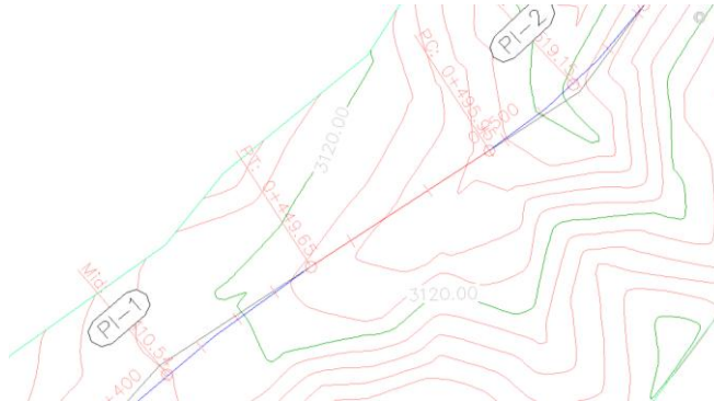
Figura 14 Etiquetado de las intersecciones de tangentes en las curvas simples
