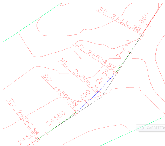
Figura 10 Curva espiral del alineamiento horizontal
