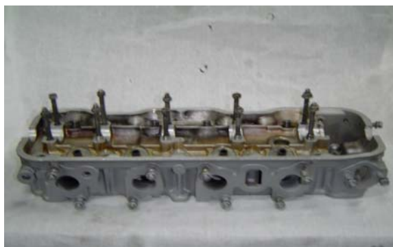
Fig.48 Verificando trizaduras en el cabezote.
