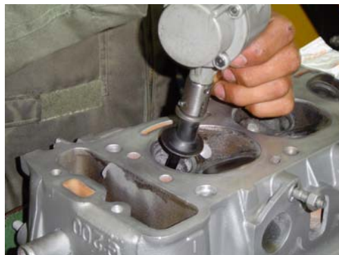
Fig.52 Asentando válvulas en sus guías.
