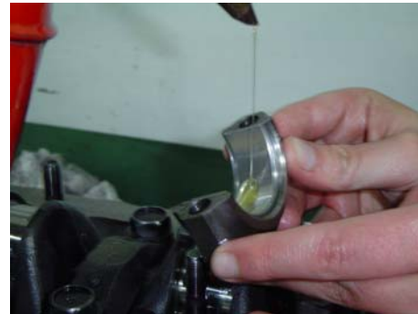
Fig.47. Lubricando los cojinetes de biela y el cigüeñal.
