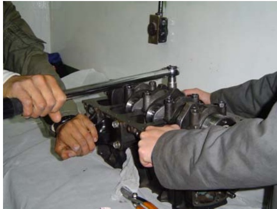
Fig.38. Damos el torque indicado por el fabricante, así mismo en tres etapas.
