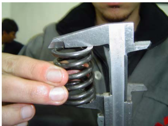
Fig.51 Muestra la forma de tomar la medida longitudinal de los muelles.
