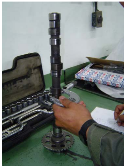
Fig.54 Midiendo las levas con un micrómetro.
