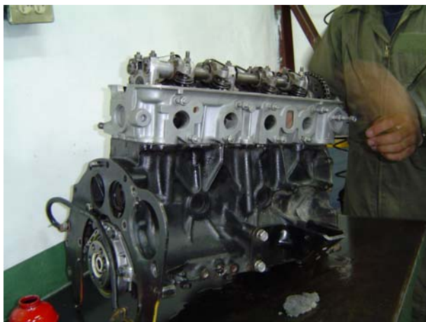
Fig.60 El motor en proceso de armado.
