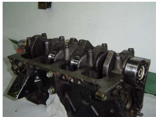
Fig.37. Colocamos las tapas de los rodamientos principales, bancadas.
