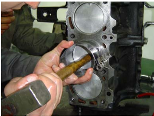
Fig.41 colocando el pistón en el cilindro
