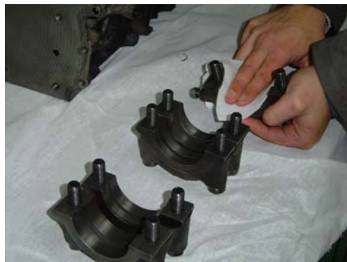
Fig.25 Limpieza de las tapas de los rodamientos principales o de bancada.
