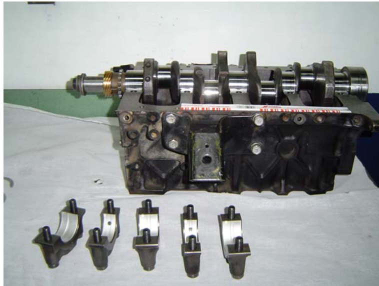
Fig.28 Montamos el cigüeñal en el bloque motor previo a las calibraciones.
