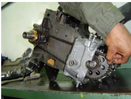
Fig.62 Muestra la distribución unida a través de una cadena.
