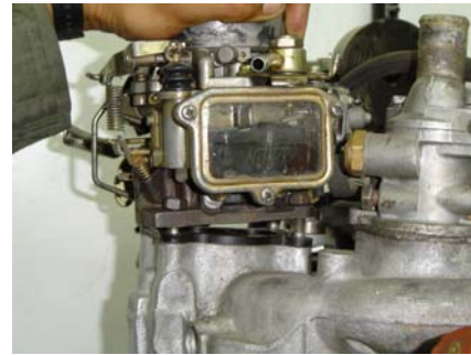
Fig.71 Instalando el carburador.
