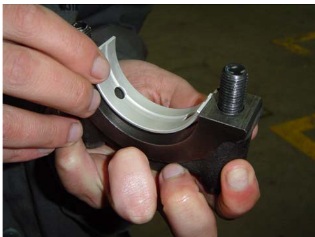
Fig.27. Montaje de los cojinetes en las tapas de los rodamientos de bancada.
