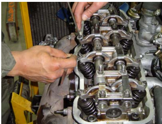
Fig.76 Calibrado de válvulas.
