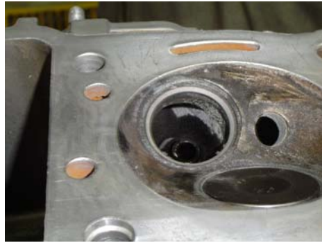
Fig.53. Luego del asentamiento debe quedar así.
