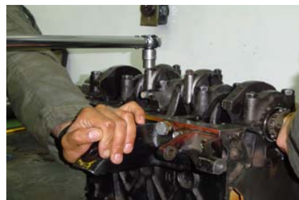
Fig.45. Dando torque a los brazos de Biela cigüeñal.
