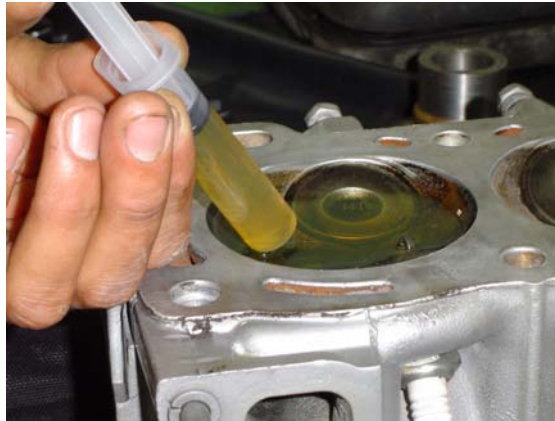
Fig.56 Midiendo el volumen de la cámara de combustión.
