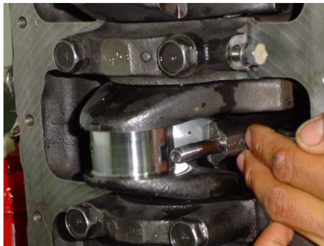
Fig.42. En esta fotografía, se puede apreciar claramente la forma en la que ingresa el brazo de biela al moñón del cigüeñal, previa la calibración.
