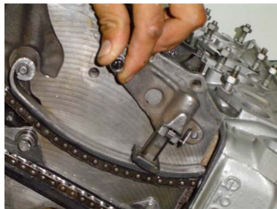
Fig.63 Colocamos el templador de la cadena, para ajustarlo debidamente.
