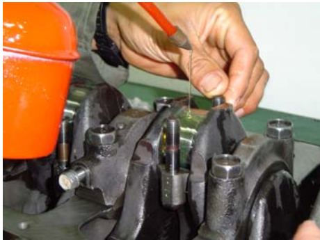
Fig.46 Lubricando los cojinetes respectivos.
