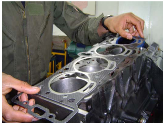
Fig.57 Colocamos el empaque entre el bloque motor y el cabezote.
