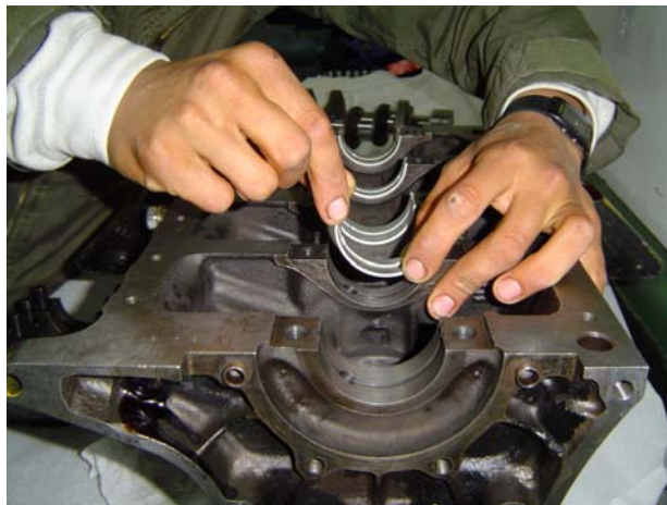
Fig.26 Montaje de los cojinetes en sus respectivas posiciones, en el bloque motor.
