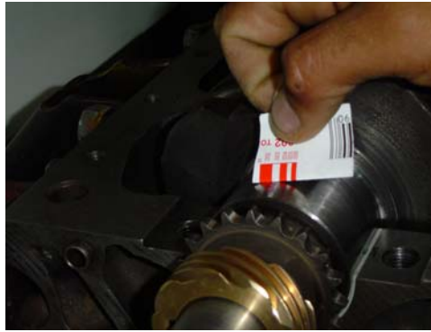
Fig.32 El gráfico indica la forma de tomar la medida, de forma correcta; en el cigüeñal.
