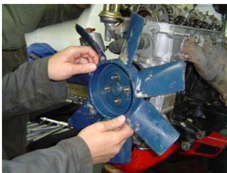
Fig.72 Instalando el ventilador.
