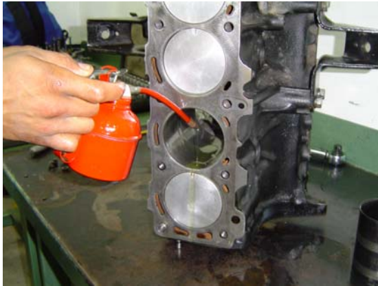
Fig.40 lubricando los cilindros
