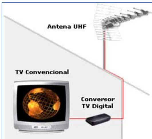
**Ilustración 45** Entrada de la señal desde la antena hasta el equipo receptor
