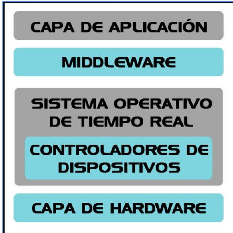
**Ilustración 25 Esquema por capas de un receptor de TDT (STB)**
