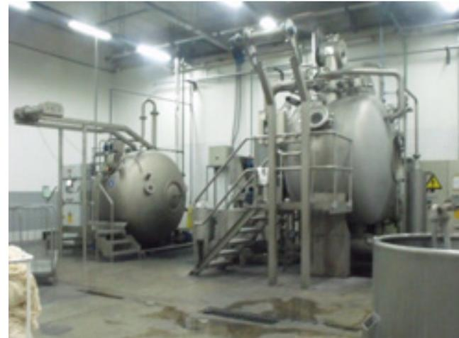
FIGURA 52: MAQUINARIA DE TINTURADO
