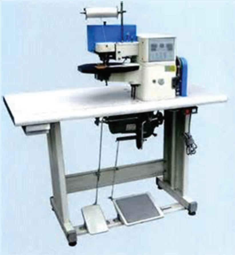
Es una máquina que mejora la producción de acuerdo a las expectativas actuales de producción por la tecnología que dispone, primero por que utiliza pegamento en silicón que es colocado en tanque de abastecimiento, al prender la máquina el silicón se diluye llega hasta las guías de virado, el operador regula el ancho de virado de las piezas según la necesidad.
