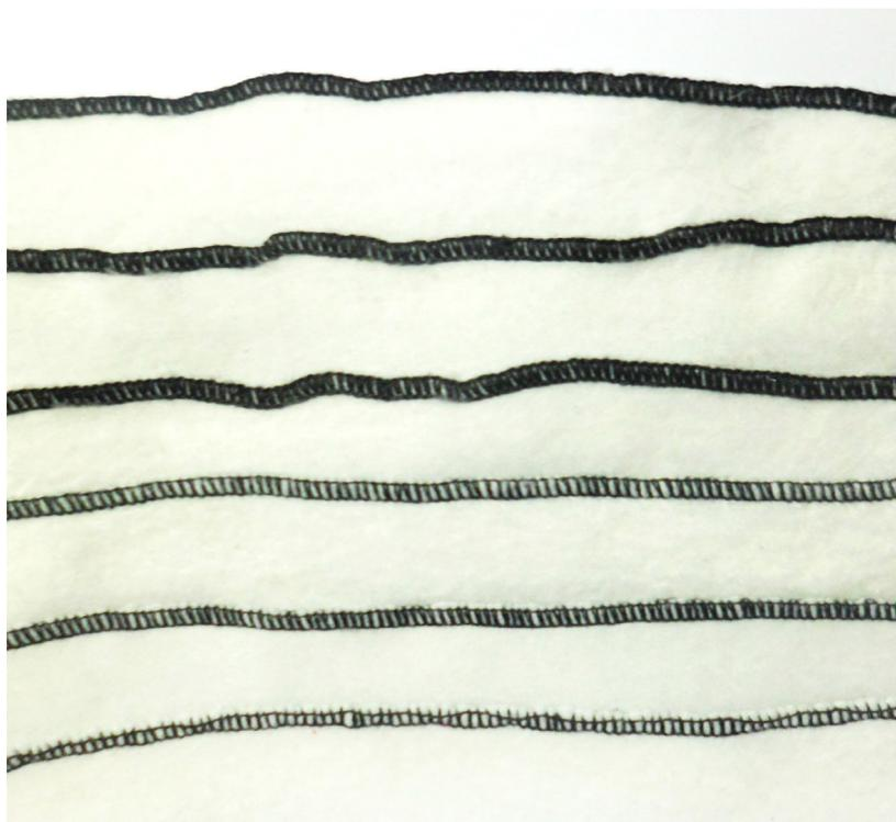
Figura 38. Muestra de experimentación de la máquina overlock de 3 hilos. Fuente: Autoría propia.
