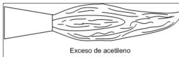
Ilustración 32 Exceso de acetileno
