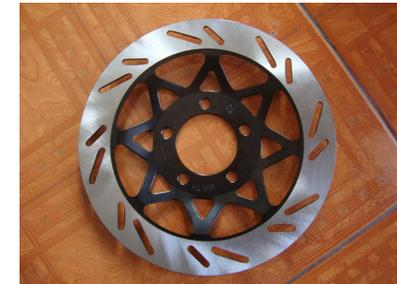
Freno posterior: discom de 9.5 pulgadas por 3mm de espesor.
