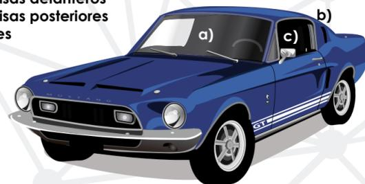
"El vidrio laminado consiste en una estructura interlaminar de dos láminas o paneles de vidrio unidos entre sí con una capa intermedia de una película o lámina de polímero (PVB) que se coloca entre las dos láminas de vidrio, es decir, es el resultado de la unión de dos o más placas de vidrio, intercalando entre ellas una o más láminas de PVB (polivinil butiral)."<sup>8</sup>
